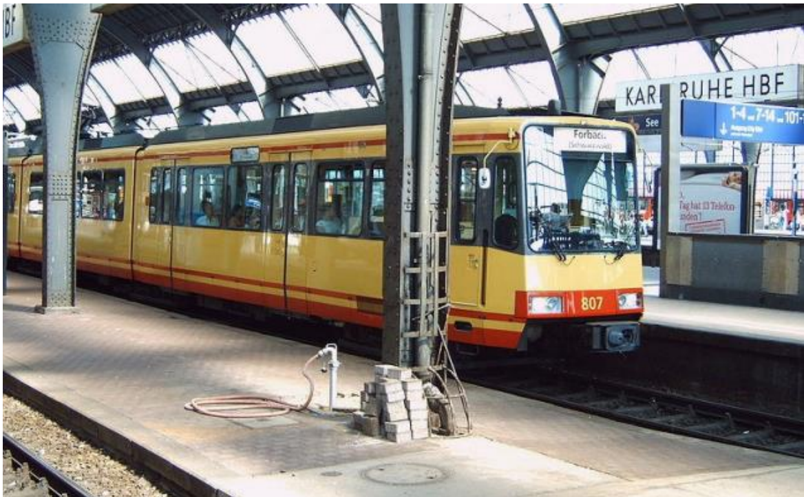
Figura 10: veicolo bimodale presso la stazione centrale [14]
