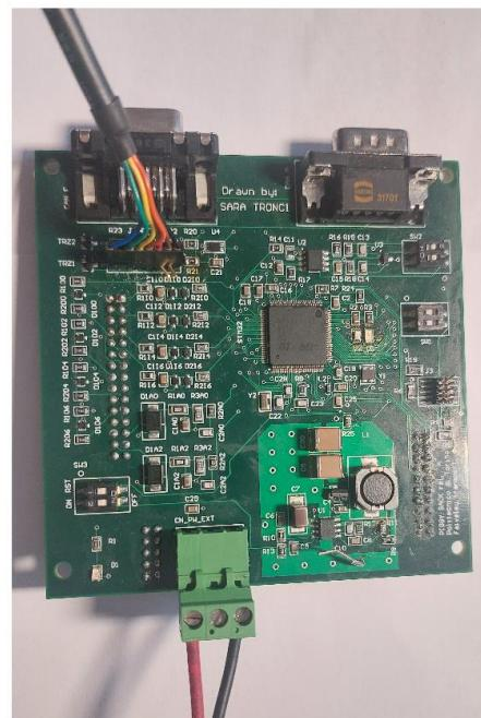
Foto Scheda Computing Unit - Lato Componenti con cavi di alimentazione e programmazione
