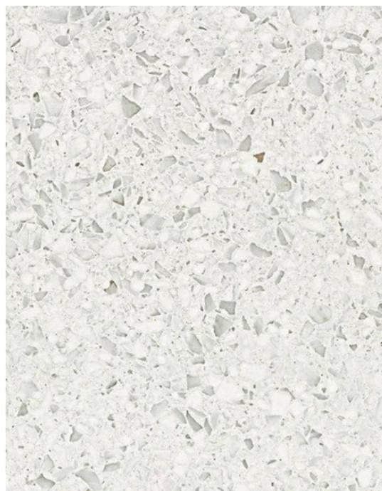
*Figura 5.27 - Particolare della pavimentazione con scarti di marmo bianco e vetro - Concord Terrazzo Company - 2019*
