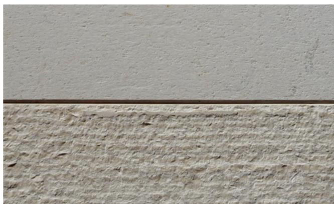
Figura 3.7 - Differenza tra un materiale lapideo rifinito con levigatura (sopra) e sabbiatura (sotto)
