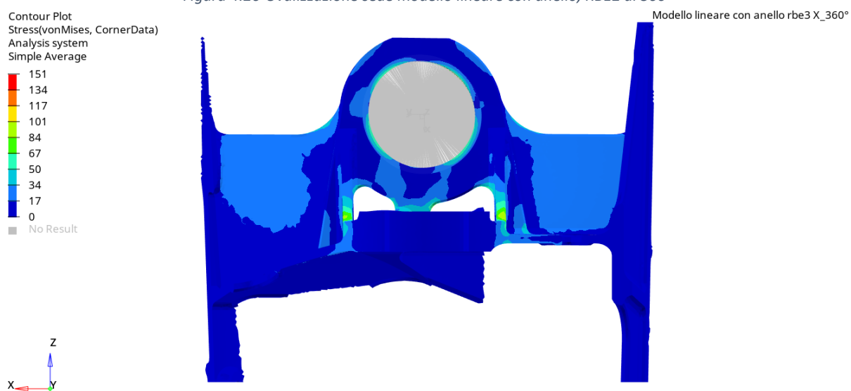
Figura 4.27-Ovalizzazione sede modello lineare con anello, RBE3 di 360°
