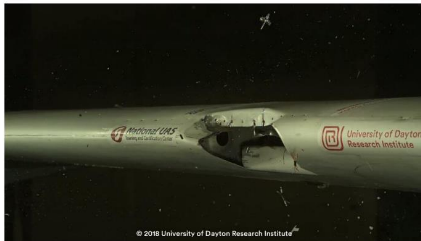
Figura 3.1: Effetto della collisione di un UAS sull'ala di un velivolo. Fonte: [60]
