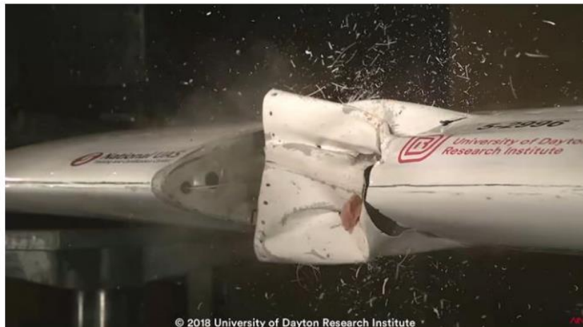
Figura 3.2: Effetto della collisione di un volatile sull'ala di un velivolo.
