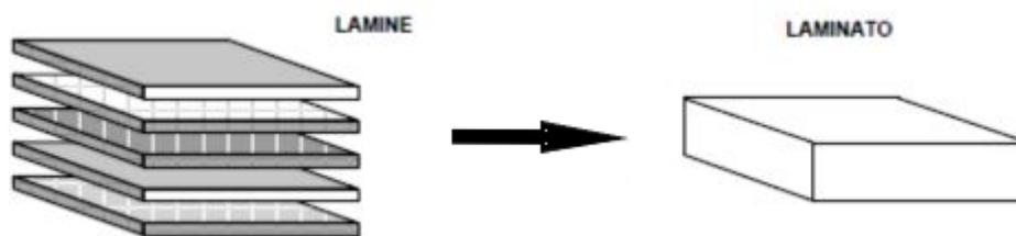
Figura 1-IX Lamina e laminato [52]
