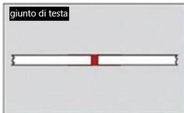
Figura 2-X Giunzione di testa [9]
