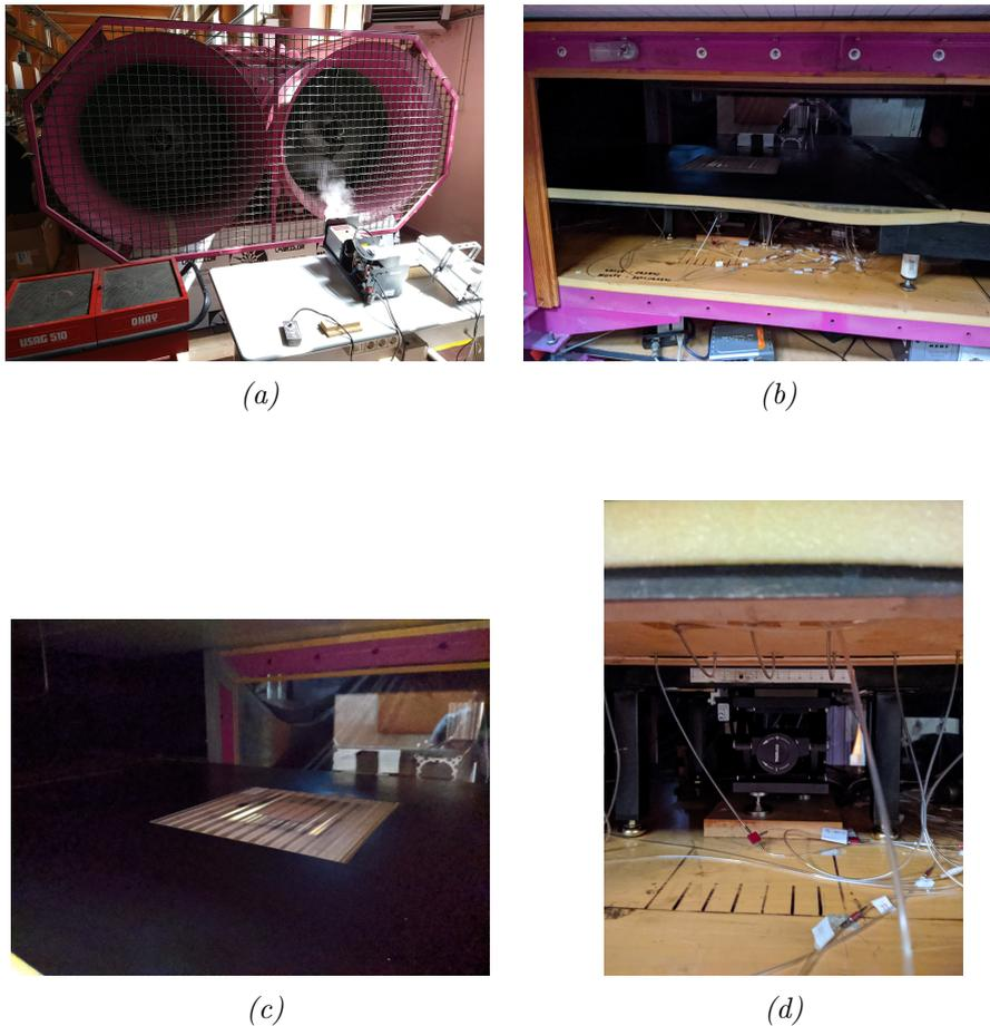
Figura 3.2: (a) i due fan e il generatore di fumo, posti a monte della galleria (b) piano posizionato a metà altezza della camera di prova (c) placca posizionata in camera di prova all'interno dell'apertura nel piano, in modo che risulti allineata al piano (d) supporto della placca posizionato sotto al piano, regolabile in altezza.
