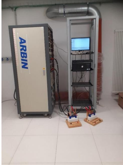
Figura 42: Arbin cycler (5 V–16 A, 8 channels) presente nel laboratorio Energy Storage del Energy Center di Torino.
