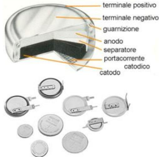
Figura 29: Struttura a bottone di una LIB [30].
