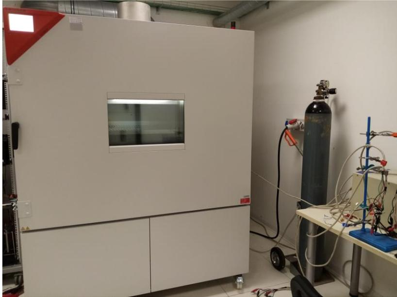
*Figura 43: camera climatica UE6 presente nel laboratorio Energy Storage del Energy Center di Torino.*
