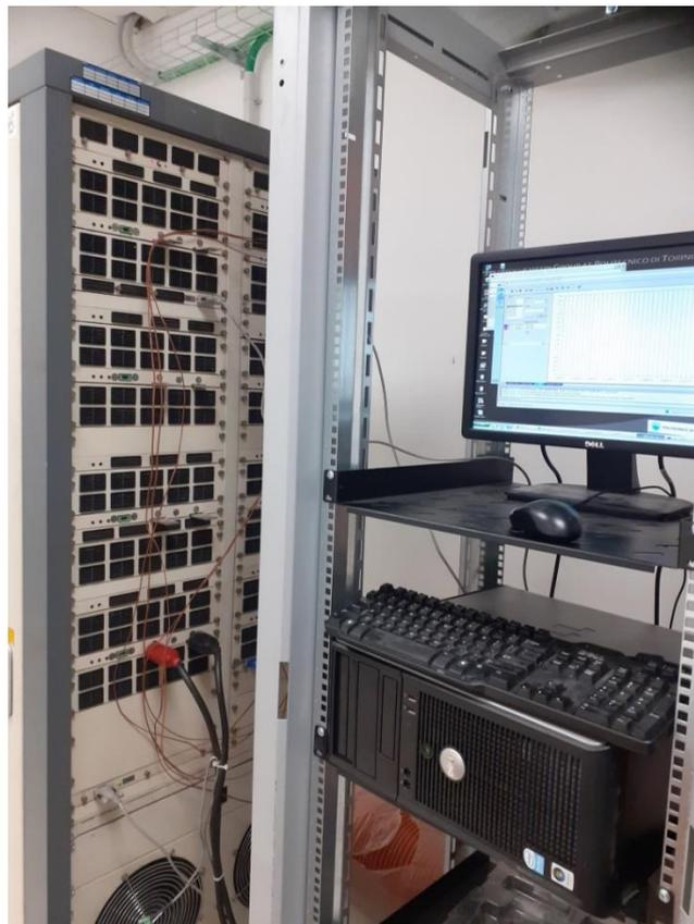
*Figura 44: Arbin Cycler BT2000 affiancato da display - laboratorio Energy Storage del Energy Center di Torino.*
