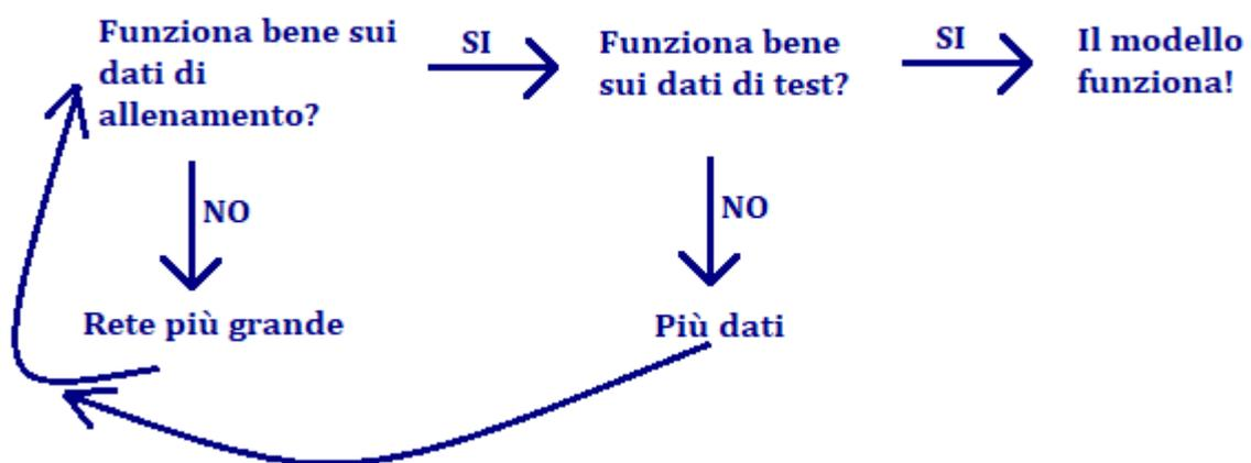
Figura 50: Procedimento adottato per realizzare il modello ANN.
