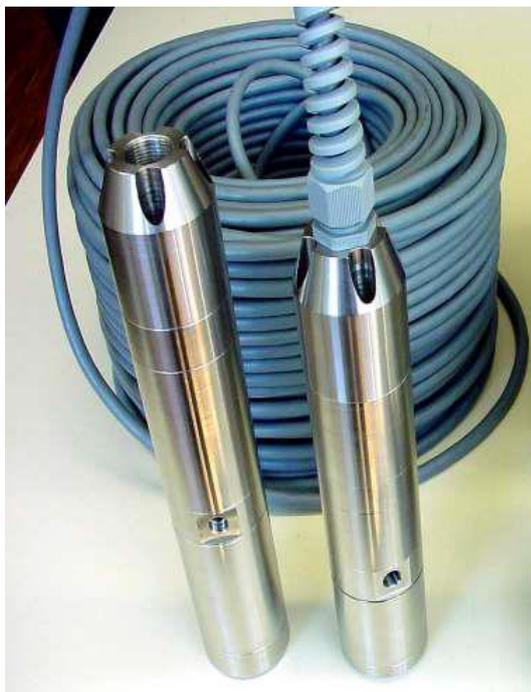
Figura 20: Componenti del fluorimetro: sonda immersa e cavo di collegamento
