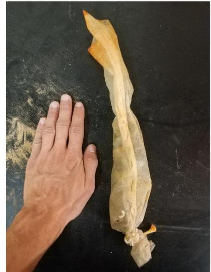
*Figura 22: Calza di geotessuto dopo l'utilizzo. Da notare la colorazione arancione dovuta alla polvere di fluoresceina*
