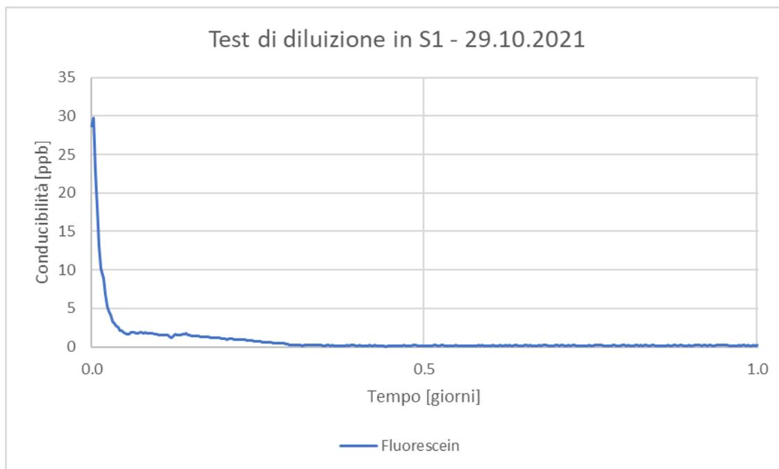
Figura 32: Curva concentrazione fluoresceina-tempo della prova ad impianto spento in S1 a 38 metri
