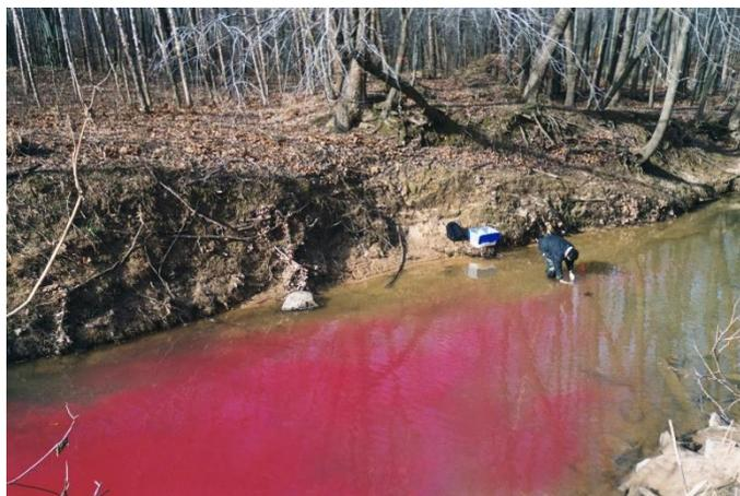
*Figura 8: Caratteristica colorazione rosa di un torrente a seguito dell'immissione di Rodamina WT nell'alveo.*
