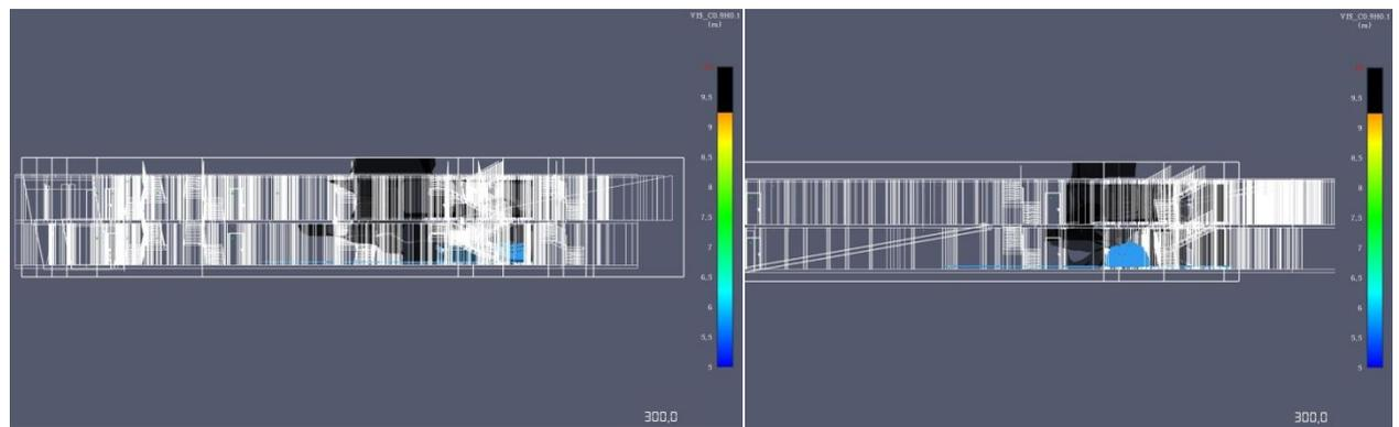
**Figura 251. Isosuperfici di visibilità a 10 metri in direzione x e y a 300 secondi**
