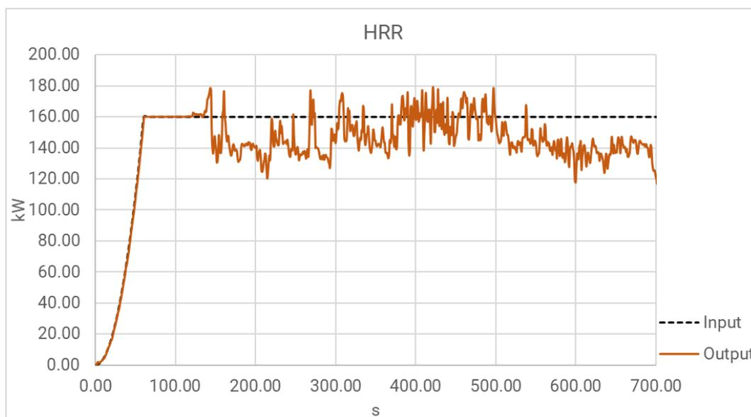
Fig. 59: Curva HRR, confronto tra input ed elaborazione del programma
