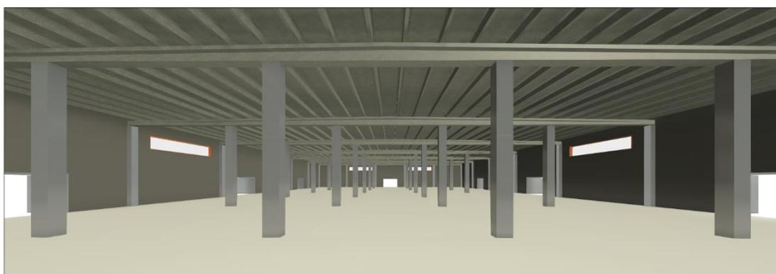
Fig. 9: Vista 3d prospettica, apparecchiatura delle travi e dei travetti a doppio T
