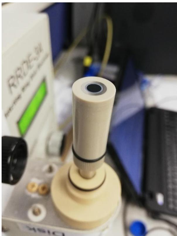
**Figura 5.13:** Elettrodo alla fine dell'asciugatura dell'inchiostro mediante RAD.
