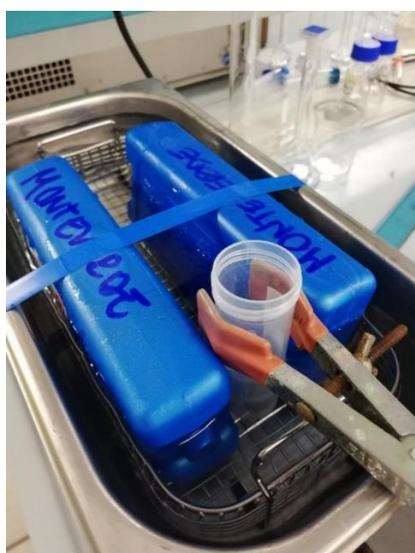
**Figura 5.9:** Dispersione mediante vasca a ultrasuoni in presenza di ghiaccio.
