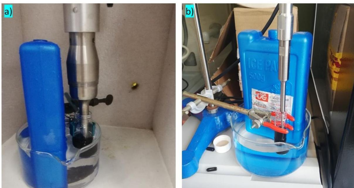
**Figura 5.10:** a) Dispersione mediante sonda a ultrasuoni di 750 W in presenza di ghiaccio; b) Dispersione mediante sonda a ultrasuoni di 135W con utilizzo di ghiaccio.
