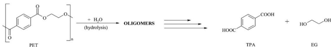
Figura 3: Reazione di idrolisi diretta del PET
