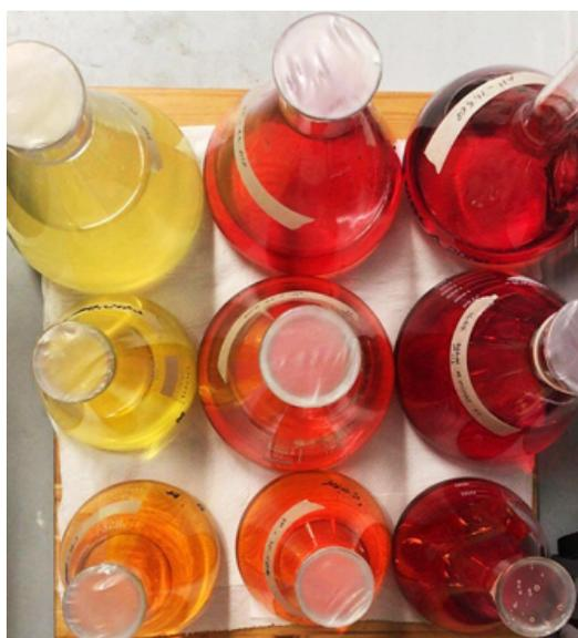
*Figura 4.19, Immagine reale delle soluzioni a pH noto dopo l'aggiunta dell'indicatore di pH.*
