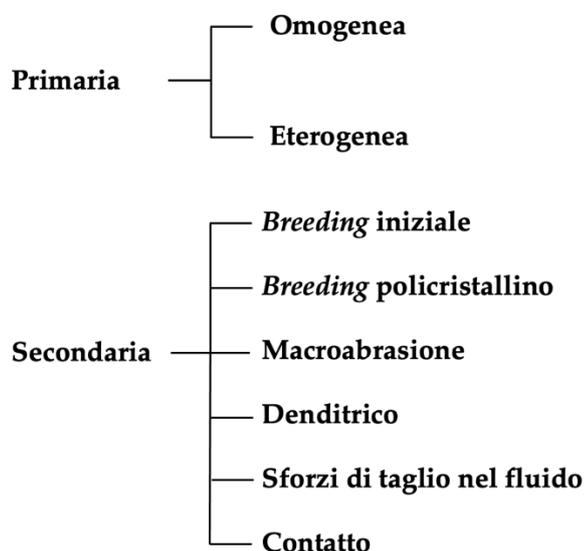
Figura 2.5, I possibili meccanismi di nucleazione [27].
