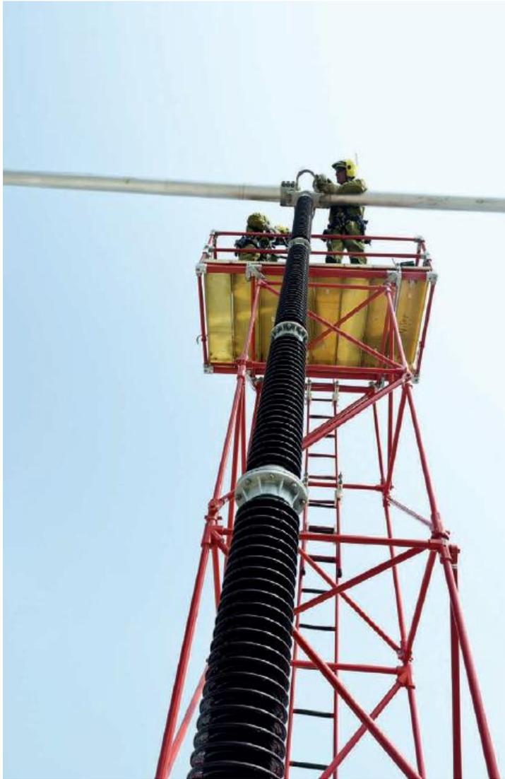
*Fig. 5.2.2: Esempio di TIP (torre isolante di posizionamento)*
