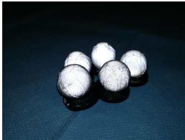
Figure 3.6 - Markers passivi catarifrangenti per motion capture
