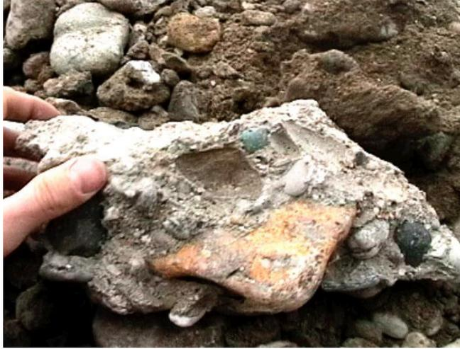
*Figura 2.15 Frammenti di terreno cementato e non-cementato (Barla & Barla, 2012)*
