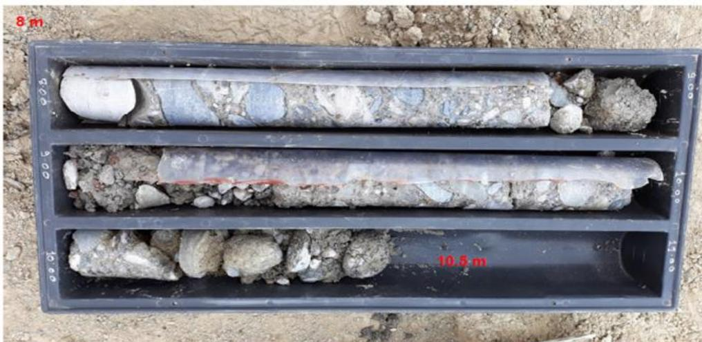
Figura 4.26 Stratigrafia e foto cassetta sondaggio ST5 (Cortesia di Lombardi Ingegneria S.r.l.)
