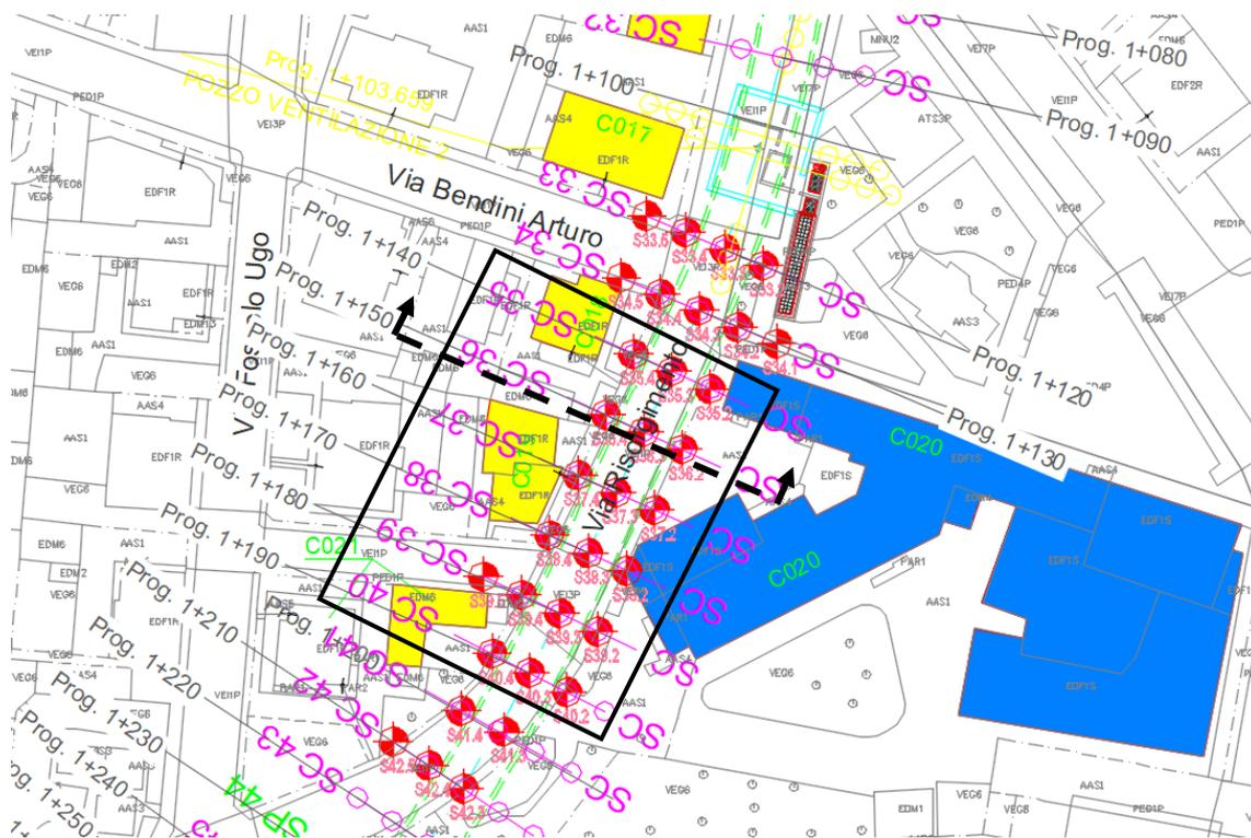
Figura 5.5 Vista in planimetria del tratto analizzato e della sezione di calcolo (Cortesia di Lombardi Ingegneria S.r.l.)
