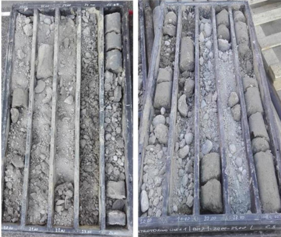
Figura 4.13 Sondaggi BH4 (a sinistra) e BH7 (a destra), dettaglio carote tra i 20 e 25 metri di profondità dal p.c.; si individuano presenti livelli di spessore da decimetrico fino a metrico particolarmente addensati (Cortesia di Lombardi Ingegneria S.r.l.)
