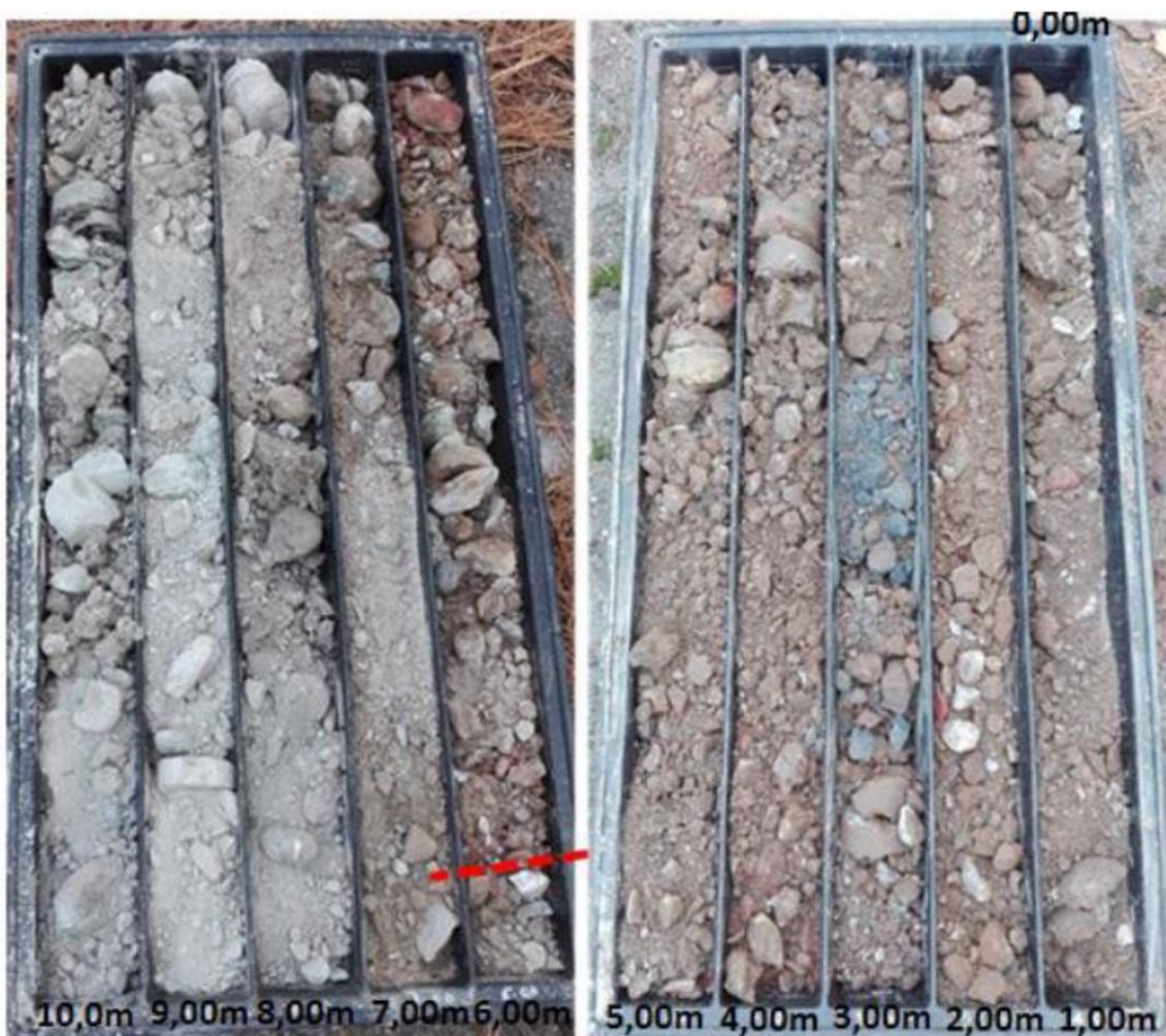
Figura 4.12 Cassette catalogatrice BH2. La linea rossa indica il limite UG0-UG1 (Cortesia di Lombardi Ingegneria S.r.l.)
