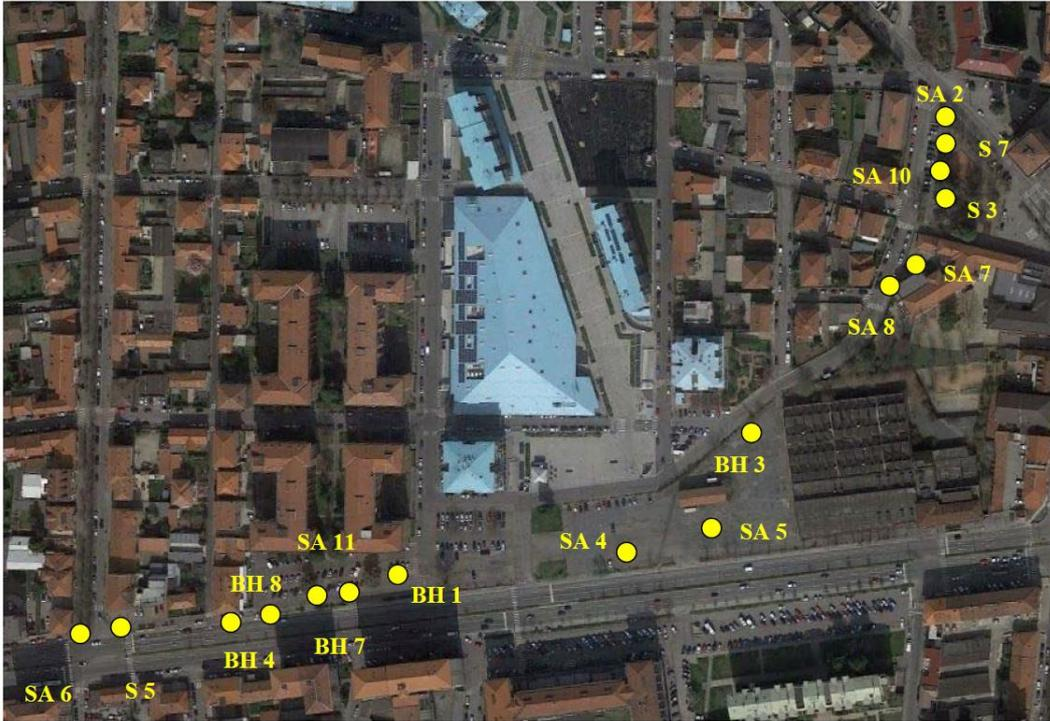
Figura 4.7 Ubicazione delle indagini eseguite - area via Risorgimento / C.so Francia (in giallo) (Cortesia di Lombardi Ingegneria S.r.l.)
