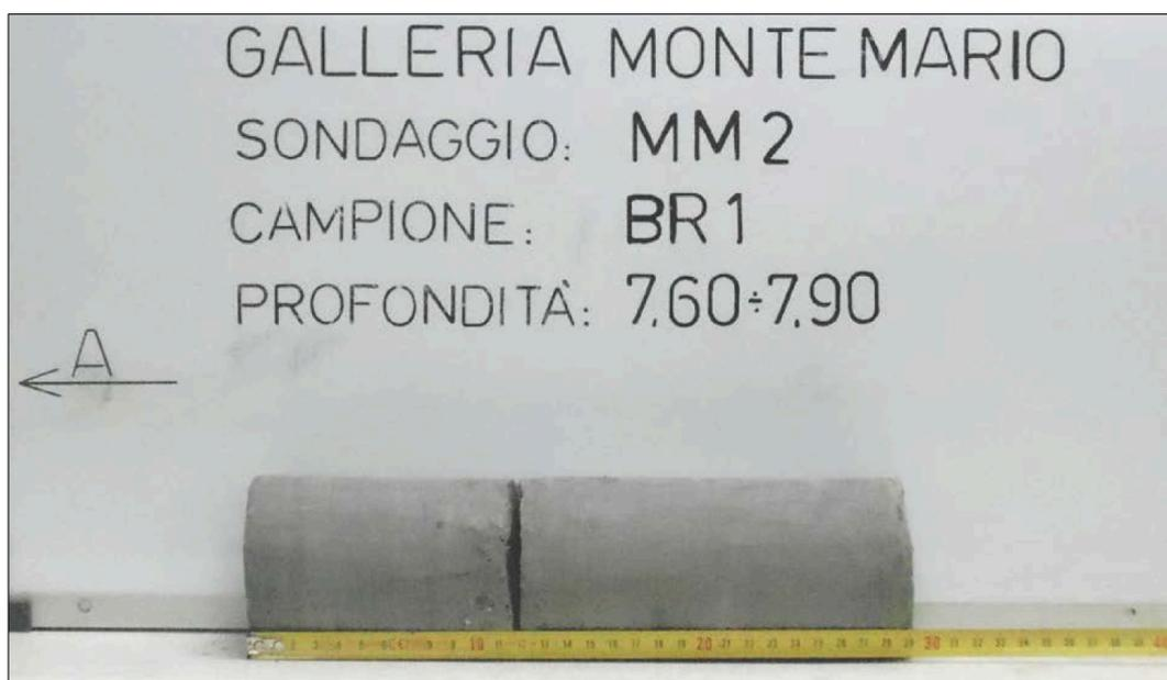
Figura 3.9: Campione da laboratorio “MM2-BR1” con relativa dimensione.
