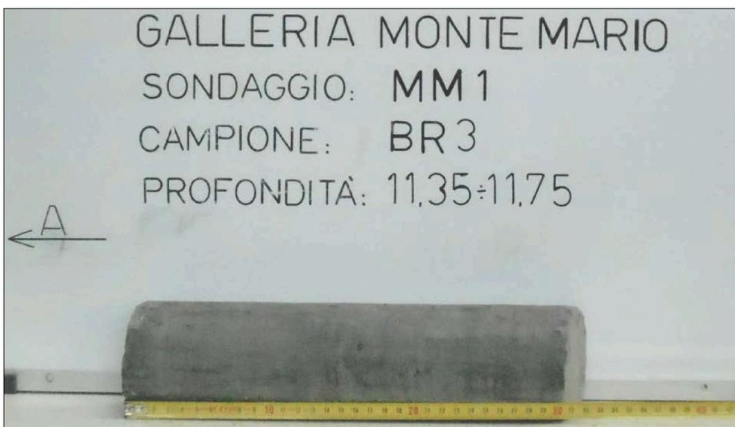
Figura 3.8: Campione da laboratorio “MM1-BR3” con relativa dimensione.
