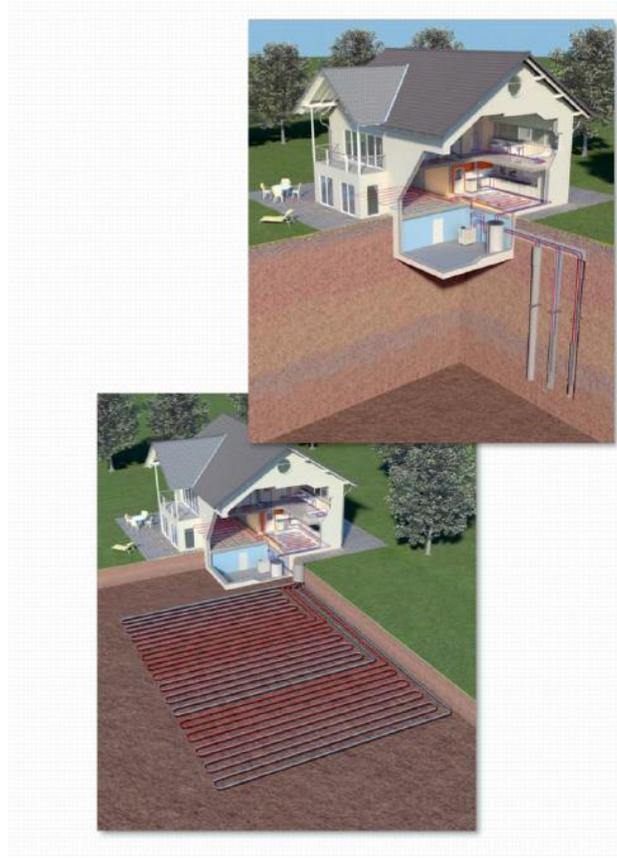
Figura 9. Schema di un sistema Closed loop (<http://old.tekneco.it/>)
