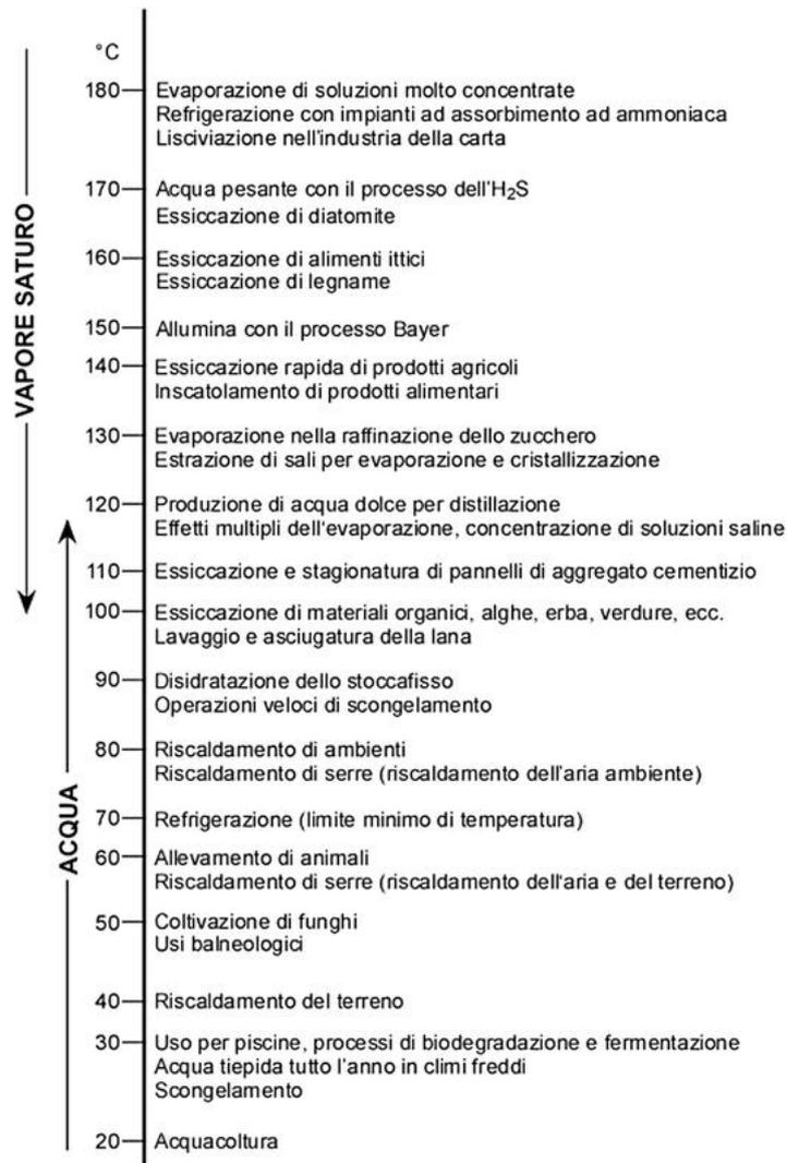
Figura 3. Diagramma che mostra l'utilizzo dei fluidi geotermali: T tra 20 e 180 °C (Lindal, 1973)
