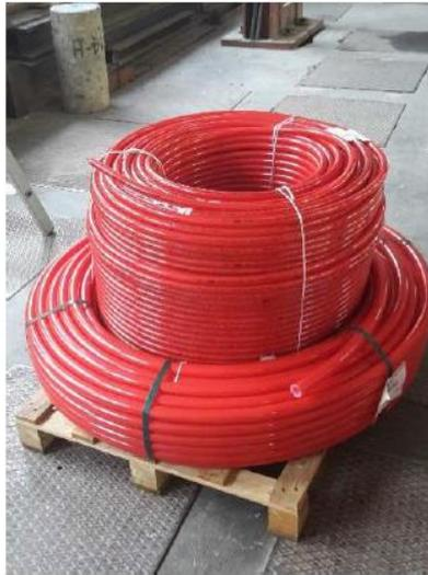
Figura 13. Tubi in polietilene adottati per le geostrutture (Barla, 2021)
