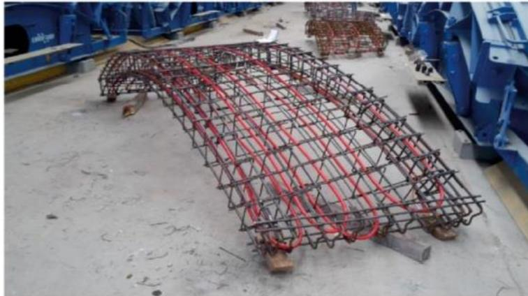
Figura 24. Conco energetico con tubi scambiatori collegati alla gabbia di armatura (Barla et al., 2019b)
