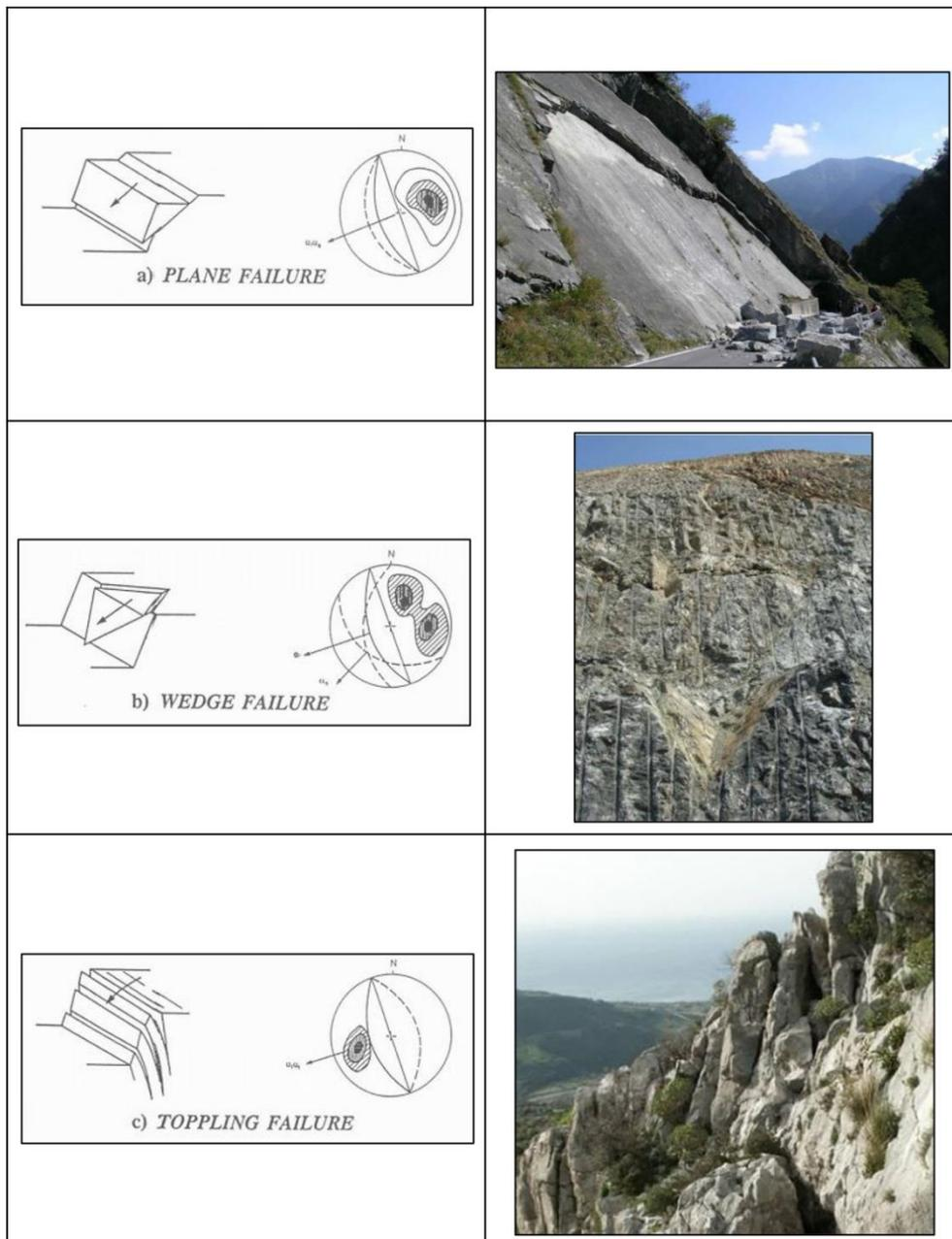
**Figura 2.1 - Tipologie di distacco da parete rocciosa: (a) Scivolamento planare dovuto a discontinuità a franapoggio; (b) Scivolamento tridimensionale di un cuneo di roccia, con giaciture a franapoggio; (c) Possibile cinematismo di roaltamento (Toppling) - (7)**
