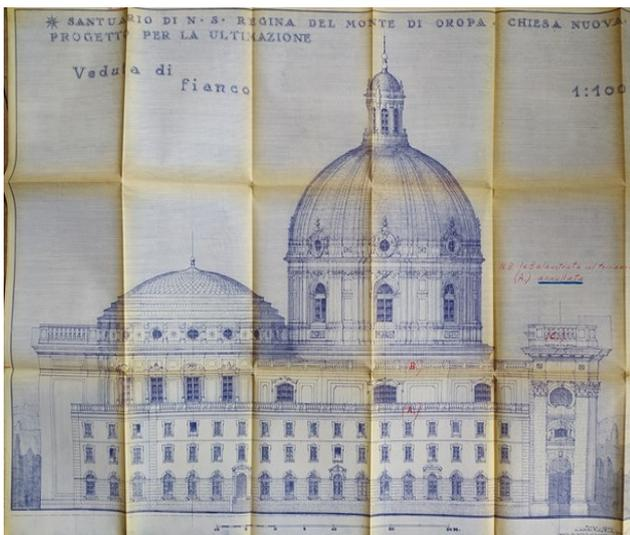
La Figura 45 riporta la vista laterale della Chiesa Nuova, essa risale agli anni precedenti il 1956, quando vennero iniziati i lavori di sostituzione della copertura molto deteriorata e sostituita con l'odierna cupola minore rappresentata nella Figura 44. Tramite la vista laterale è stato possibile risalire alle altezze dei piani delle due ali laterali e risalire allo spessore dei solai in laterocemento.
