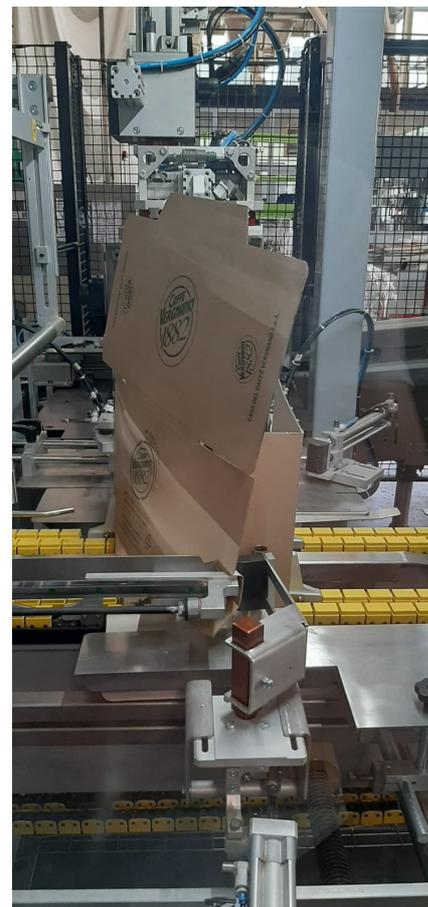
*Figura 5.7. Distruzione in macchina di un cartone per imballaggi secondari*
