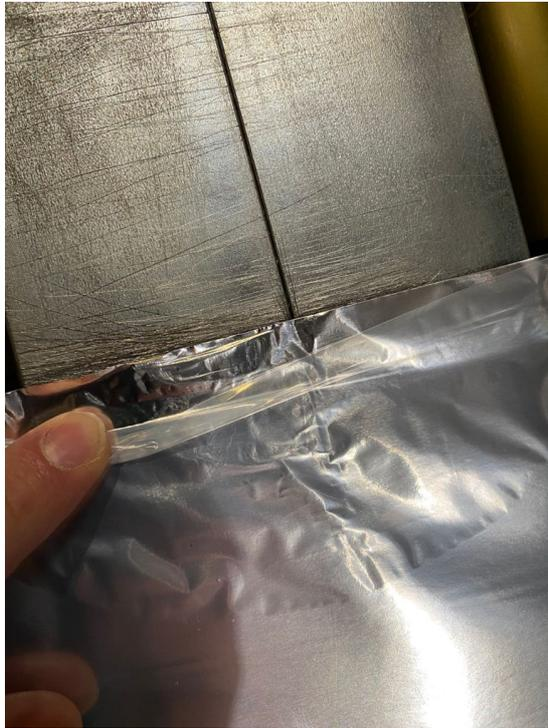
*Figura 5.3. Esempio di come si staccava la pellicola trasparente facente parte del triplice strato della bobina*
