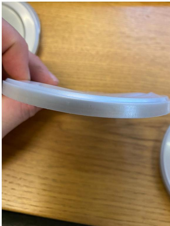
*Figura 5.2. Esempio di coperchi "imbarcati"*
