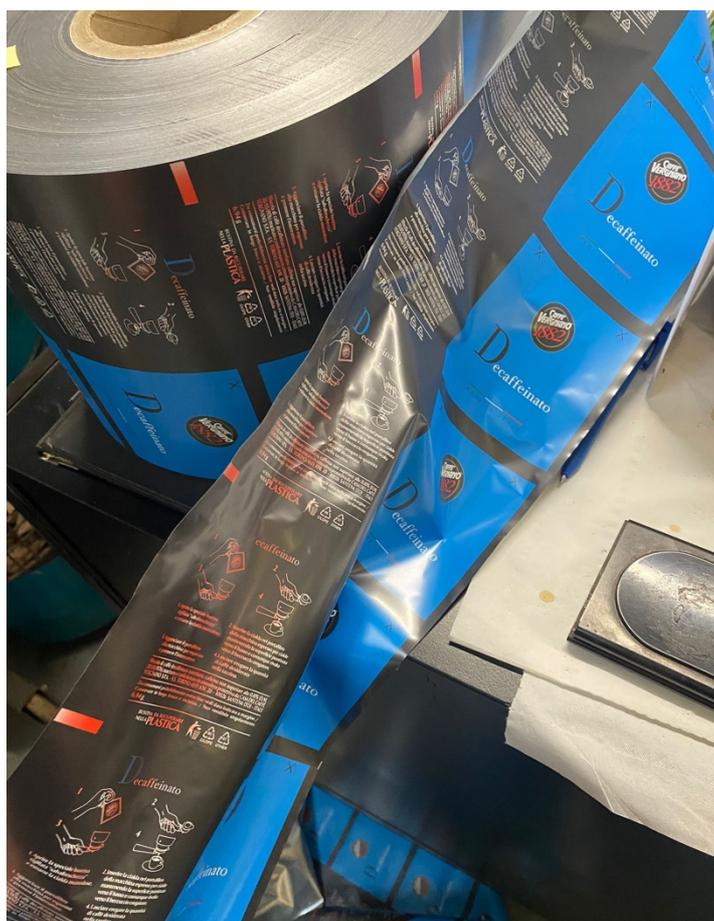
Figura 5.5. Esempio di un altro difetto di stampa su un incarto flessibile in bobina
