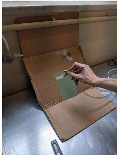
**Figura 3.4:** Preparazione del pattern sul provino tramite areografo.
