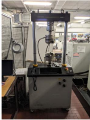
(a) Sistem di test servo idraulico Instron 8801
