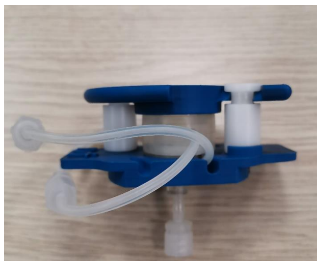
Fig. 23: Configurazione del bioreattore con collegamento sporgente dal lato basale
