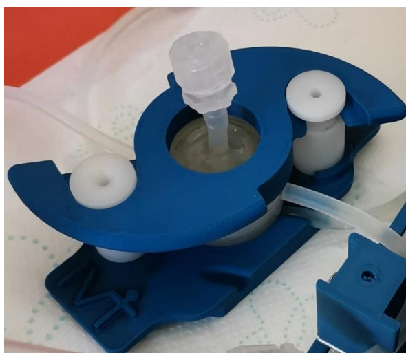
Fig. 22: Configurazione del bioreattore con collegamento sporgente dal lato apicale
