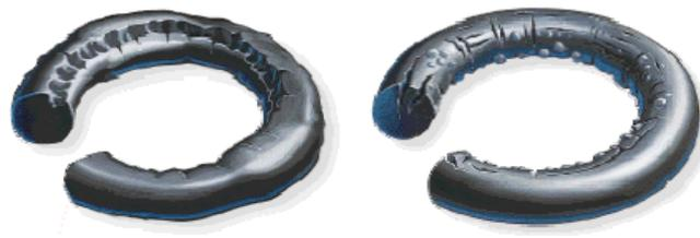
**Figura 2.3:** (a) Degrado chimico (b) Decompressione esplosiva. [9]
