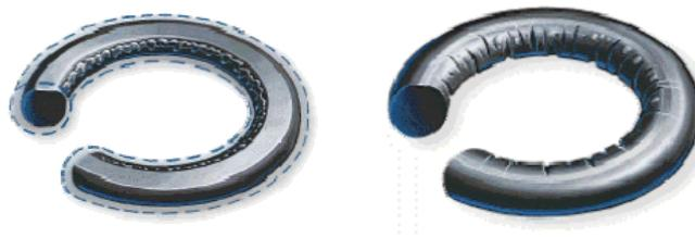
**Figura 2.4:** (a) Outgassing (b) Degrado termico. [9]
