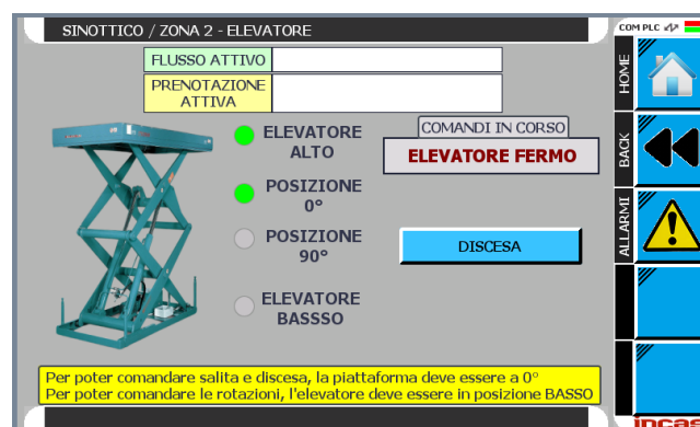
Figura 5. 82 - HMI piano 1 - Sinottico zona e elevatore [18]
