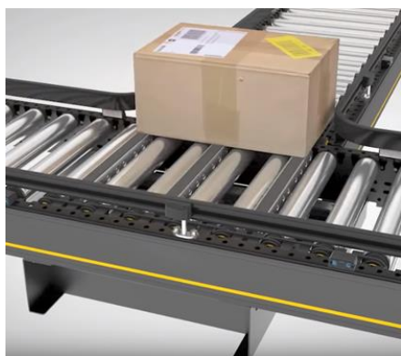
Figura 3. 10 - Deviazione a 90° con trasferitore a cinghia [10]
