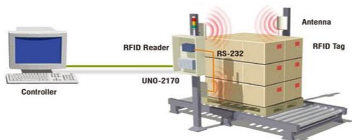
Figura 3. 16 - Schema di funzionamento della tecnologia di decodifica RFID
