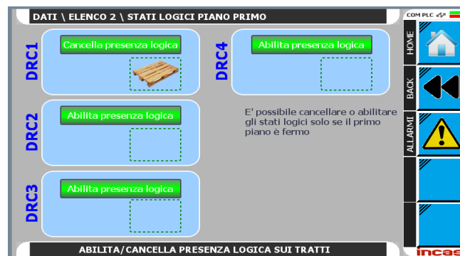
Figura 5. 84 - HMI piano 1 - Dati - Stati logici piano primo [18]
