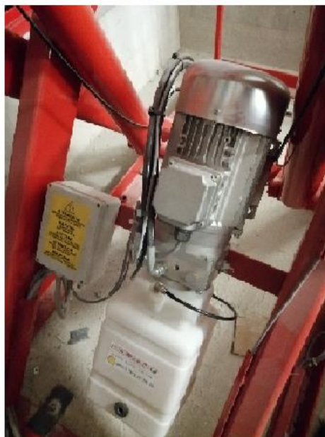
Figura 5. 5 - Schema del sistema motore-pompa-serbatoio e caso reale
