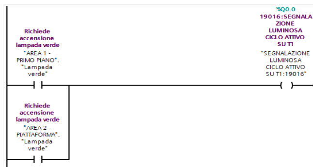
Figura 5. 36 - Gestione segnalazione luminosa ciclo attivo su T1 [18]
