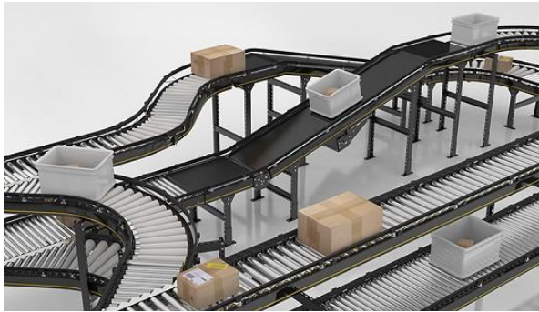
Figura 2. 1 - Sistema di movimentazione colli su rulliere [10]
