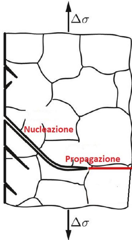
Figura 4.2: seconda fase con propagazione della cricca [7]
