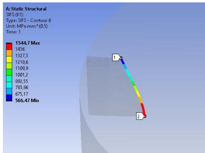
Figura 6.41: avanzamento del fronte della cricca radiale
