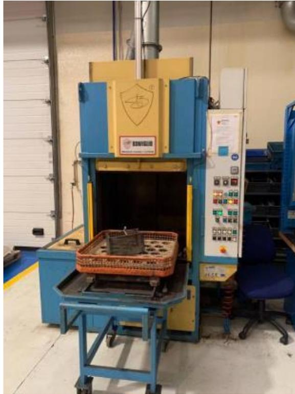
Fig.3.29 Macchina da lavaggio Bonfiglio
