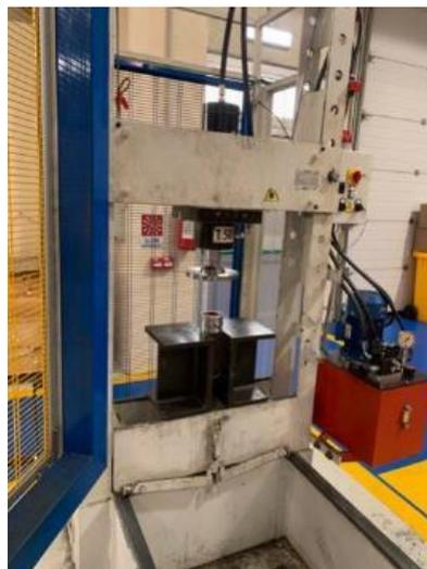
Fig.3.30 Pressa elettroidraulica
