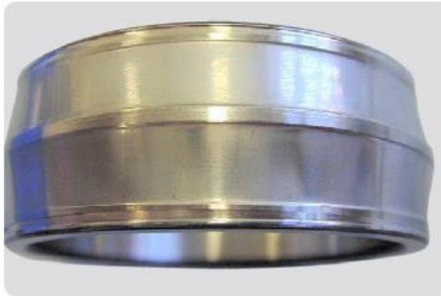
*Fig.4.4 Usura per scarsa lubrificazione*
