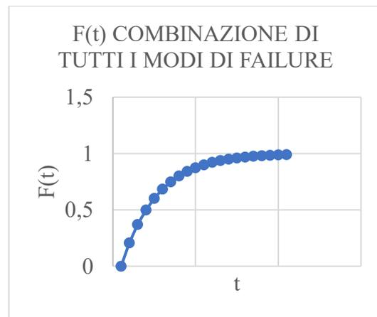
Fig.4.2b Affidabilità considerando tutte le modalità di failure
