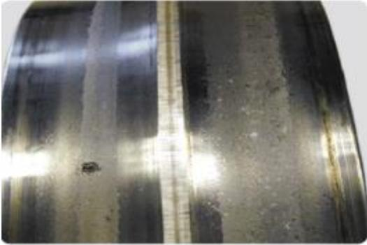
*Fig.4.3a Usura anello interno cuscinetto a sfere*
