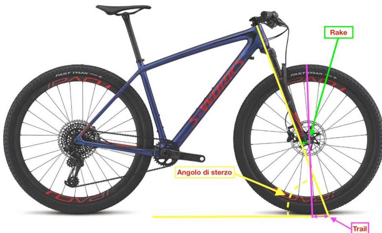
Figura 3.1 Parametri geometrici, "<https://www.mtbcult.it/tecnica/angolo-di-sterzo-e-rake-della-forcella/>"
