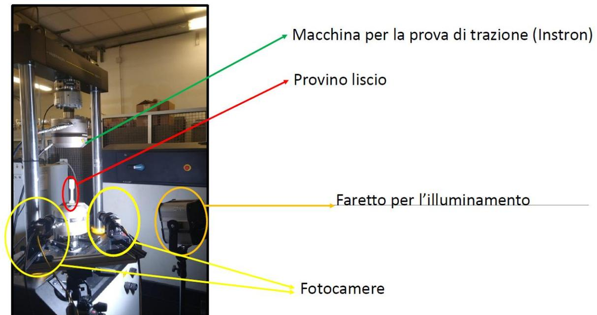
Figura 19: Banco di prova caso provino liscio.
