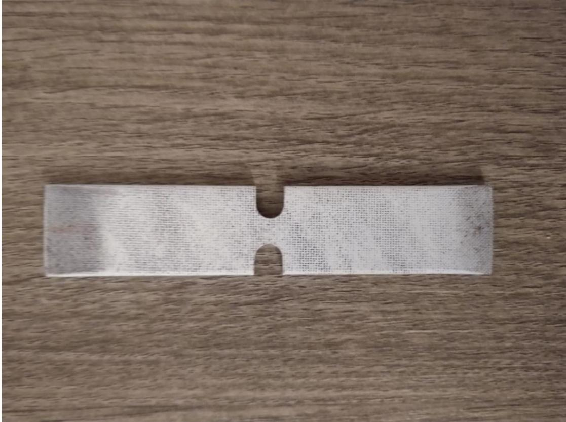
Figura 77: provino da utilizzare nella prova del provino intagliato.
