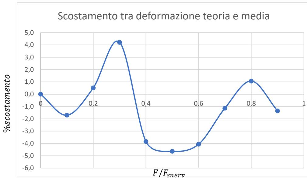
Figura 37: scostamento percentuale tra deformazione teorica e deformazione media.
