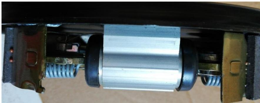
*Figura 10 Cilindretto montato sul freno*
