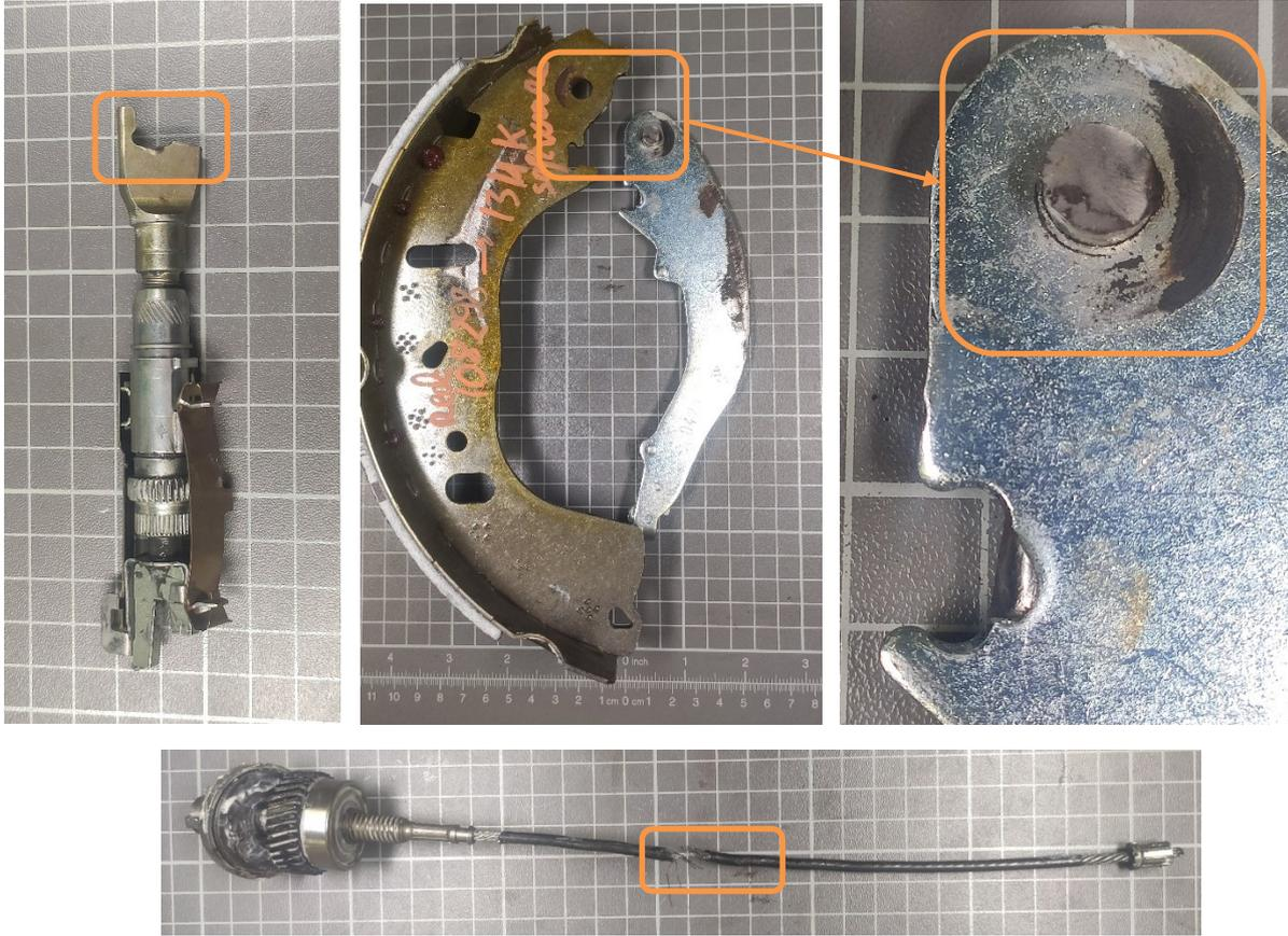
Parte dell'acquisizione dei dati è mostrata qui sotto. Durante questi test si è notato che l'adj tende a chiudersi. In questo test la rotazione dell'adj non è stata inibita. Per un certo tot di cicli non è stato raggiunto il carico massimo.
