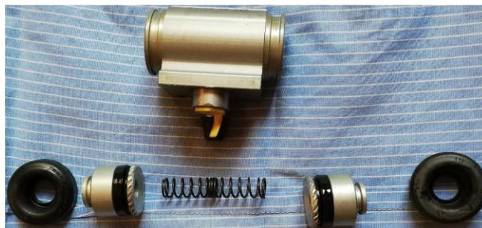
Figura 8 Componenti del cilindretto
