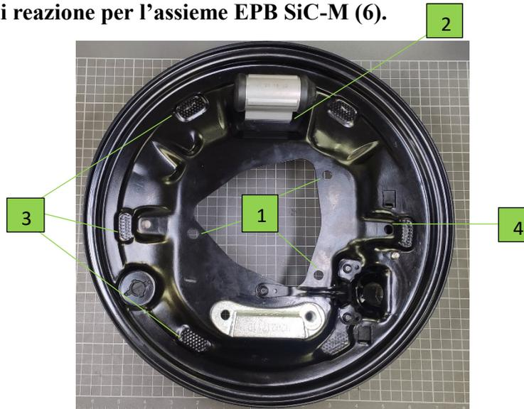
Figura 5 Piatto con cilindretto e reaction block
