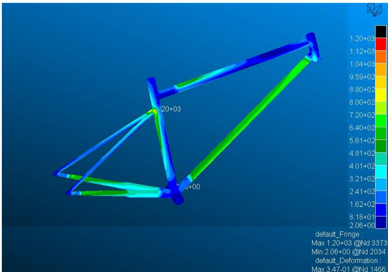
Figura 55 - Stato tensionale telaio in composito
