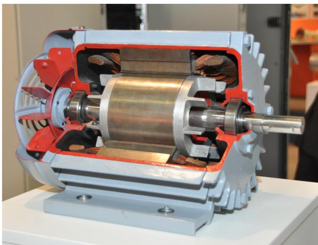
**Figura 4.1:** Immagine esemplificativa. Vista interna, taglio di 90° attraverso la camicia e gli avvolgimenti statorici di rame.<sup>4</sup>
