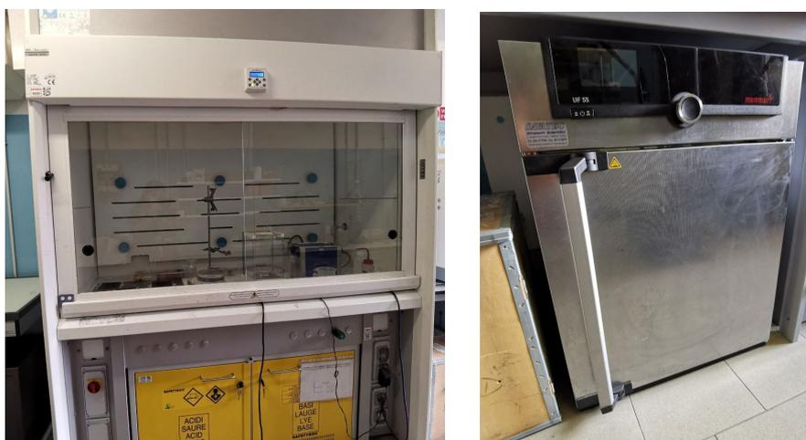
Figura 3.3. (a) Cappa aspirante. (b) Stufa termostatica.
