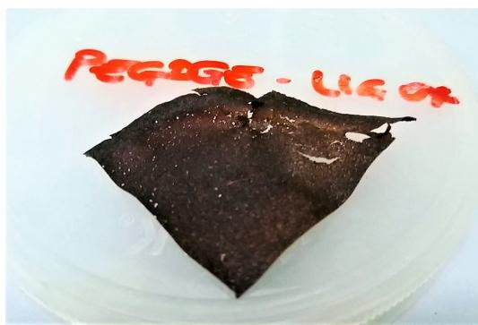
Figura 3.20. Membrana in lignina ottenuta mediante reticolazione con PEGDGE.
