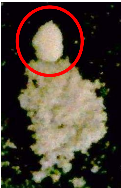
Fig.20 – Osservazione al microscopio ottico delle polveri di Bi 2 O 3 si può notare chiaramente un aggregato di grosse dimensioni, evidenziato in rosso.
