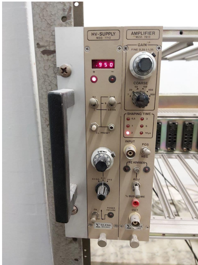
Fig.28 – Schede elettroniche di amplificazione, a destra, e di alimentazione, a sinistra.
