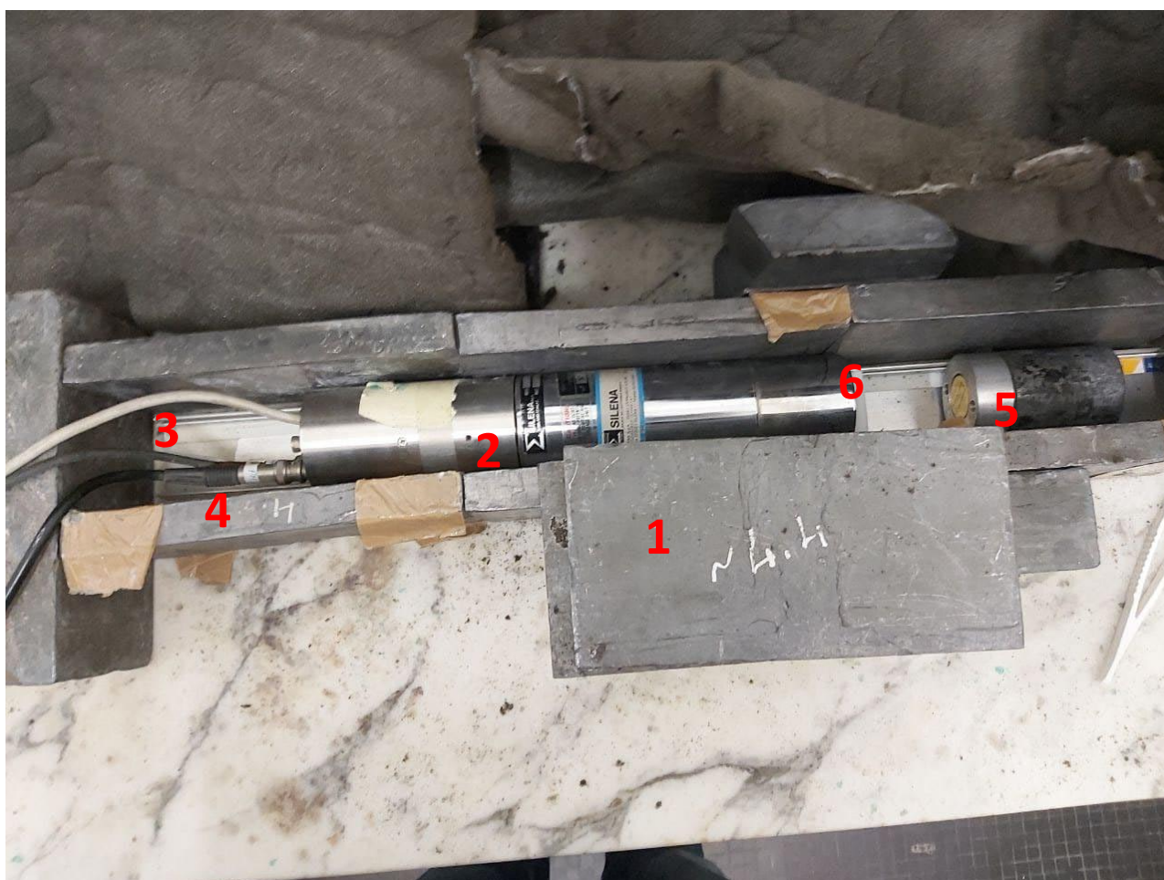
Fig.27 – Set-up sperimentale di misura per la spettrometria gamma. Si possono identificare la gabbia di Pb (1), il fototubo con preamplificatore (2), i cavi di alimentazione (3) e amplificazione (4), la sorgente radioattiva di Co-60 (5) e i campioni pronti per essere testati (6).
