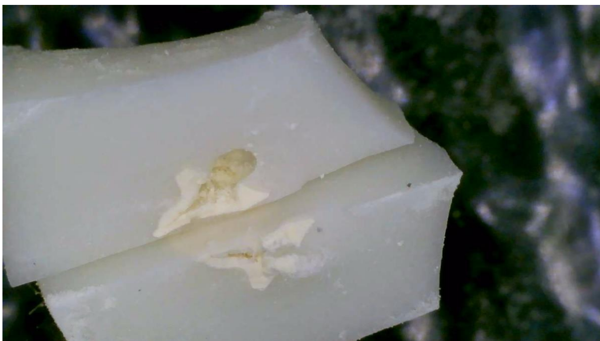
Fig.23 – Osservazione al microscopio ottico della porosità nei pressi degli aggregati di \text{Bi}_2\text{O}_3 nella matrice siliconica sul fondo del provino.
