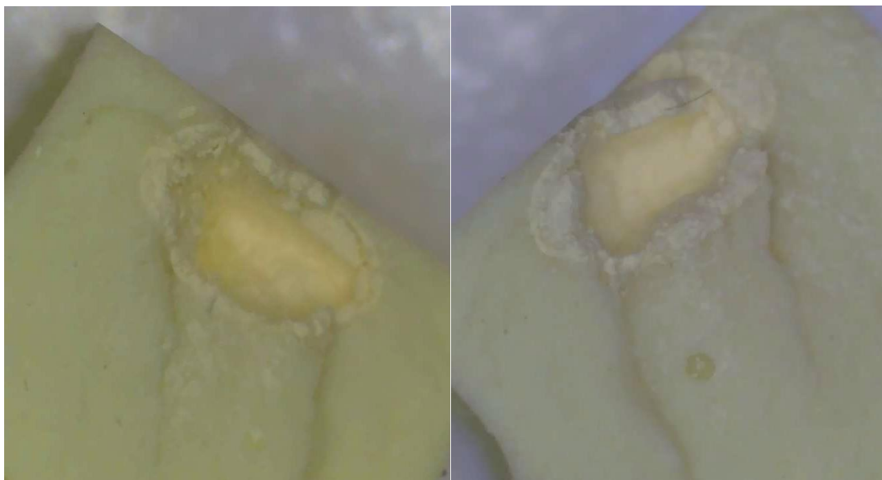
Fig.38 – Aggregati di dimensioni millimetriche nei campioni caricati al 50%.
