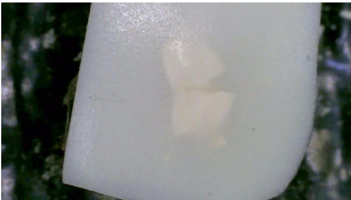
Fig.22 – Osservazione al microscopio ottico degli aggregati di Bi 2 O 3 nella matrice siliconica sul fondo del provino.
