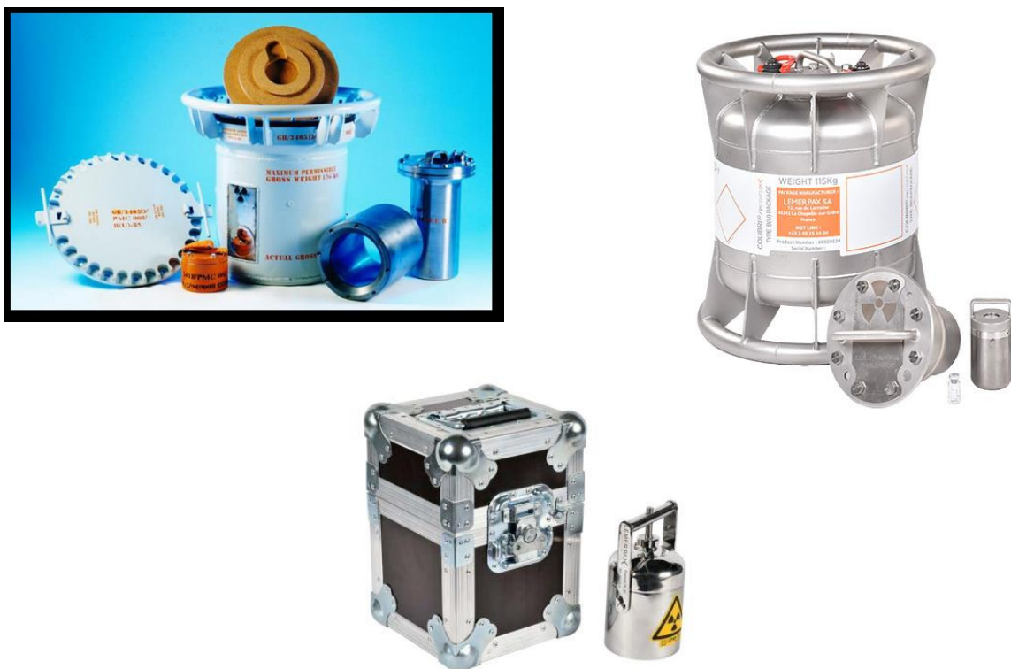
Fig.1 – in figura sono riportati contenitori di tipo C (alto sinistra), B ( alto destra) e A (in basso). Si osserva come il tipo C ha più strati di protezione inseribili e che la geometria e i material sono ottimizzati per resistere a maggiori sollecitazioni.
