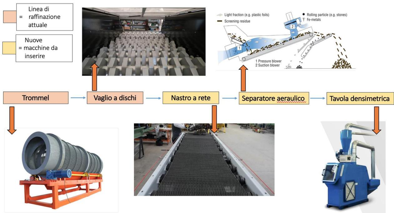
*Figura 6.6: Schema a blocchi dei macchinari costituenti la proposta per la nuova linea di raffinazione di GAIA*
