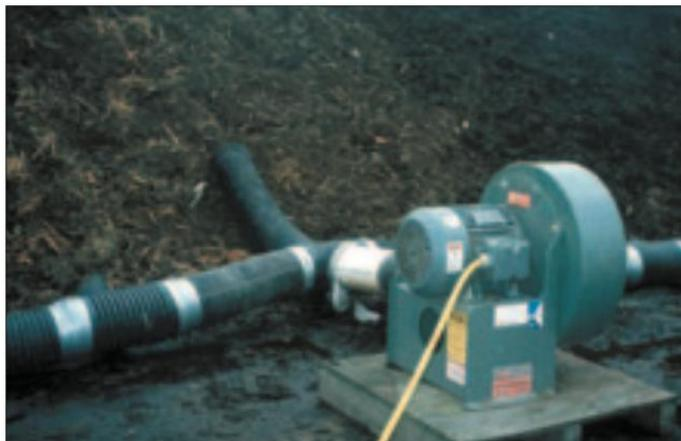
*Figura 1.5: Soffiante per il compostaggio con cumuli aerati per insufflazione.*
