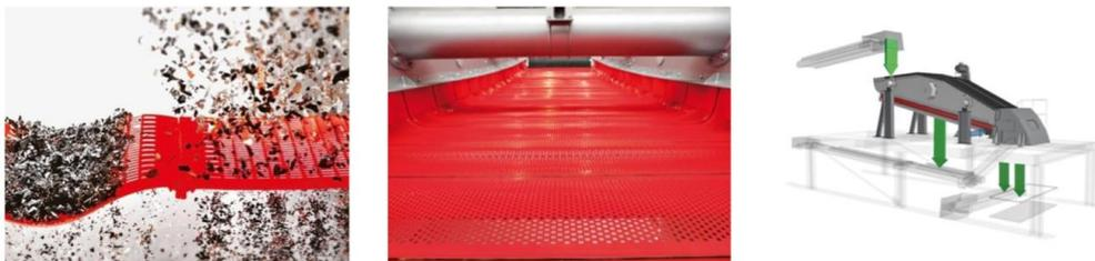
*Figura 4.7: Nastro flessibile BIVITEC*
