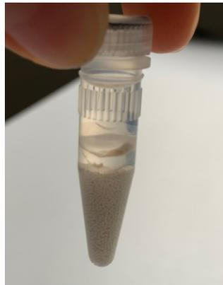
Figura 16: Separazione tra surnatante con RNA dalle sfere di zirconia come descritto dal punto 5
