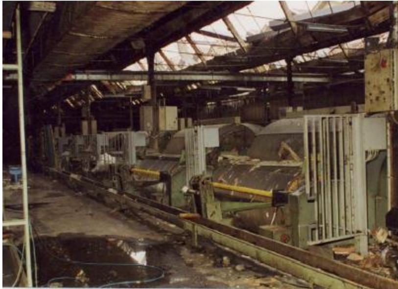
**Figura 3.8:** Vista delle carde sotto le quali si è sviluppato l'innesco [13]
