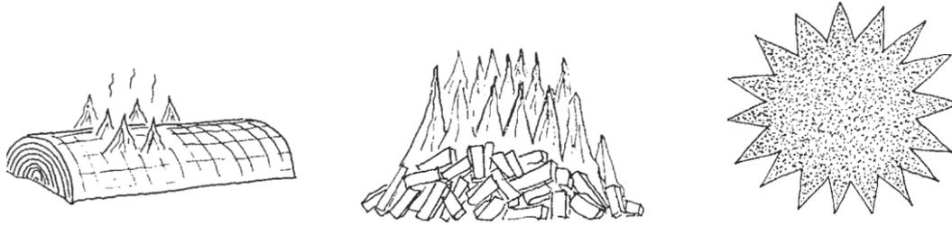
**Figura 3.4:** *La velocità di combustione aumenta all'aumentare della superficie esposta per unità di volume. [8]*
