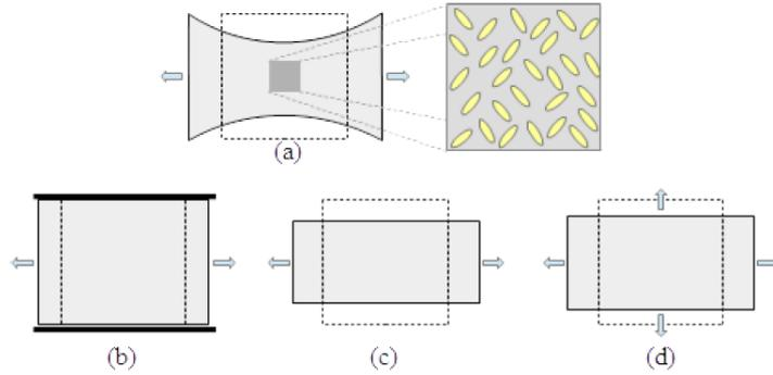
Figura 1.2. Diversi tipi deformazioni del substrato: (a) trazione uni-assiale con vincolo *carrello* sui bordi laterali, (b) deformazione puramente uni-assiale, (c) allungamento uni-assiale, (d) deformazione bi-assiale.
