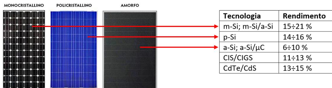
Figura 2.1: Tipi di pannelli fotovoltaici
