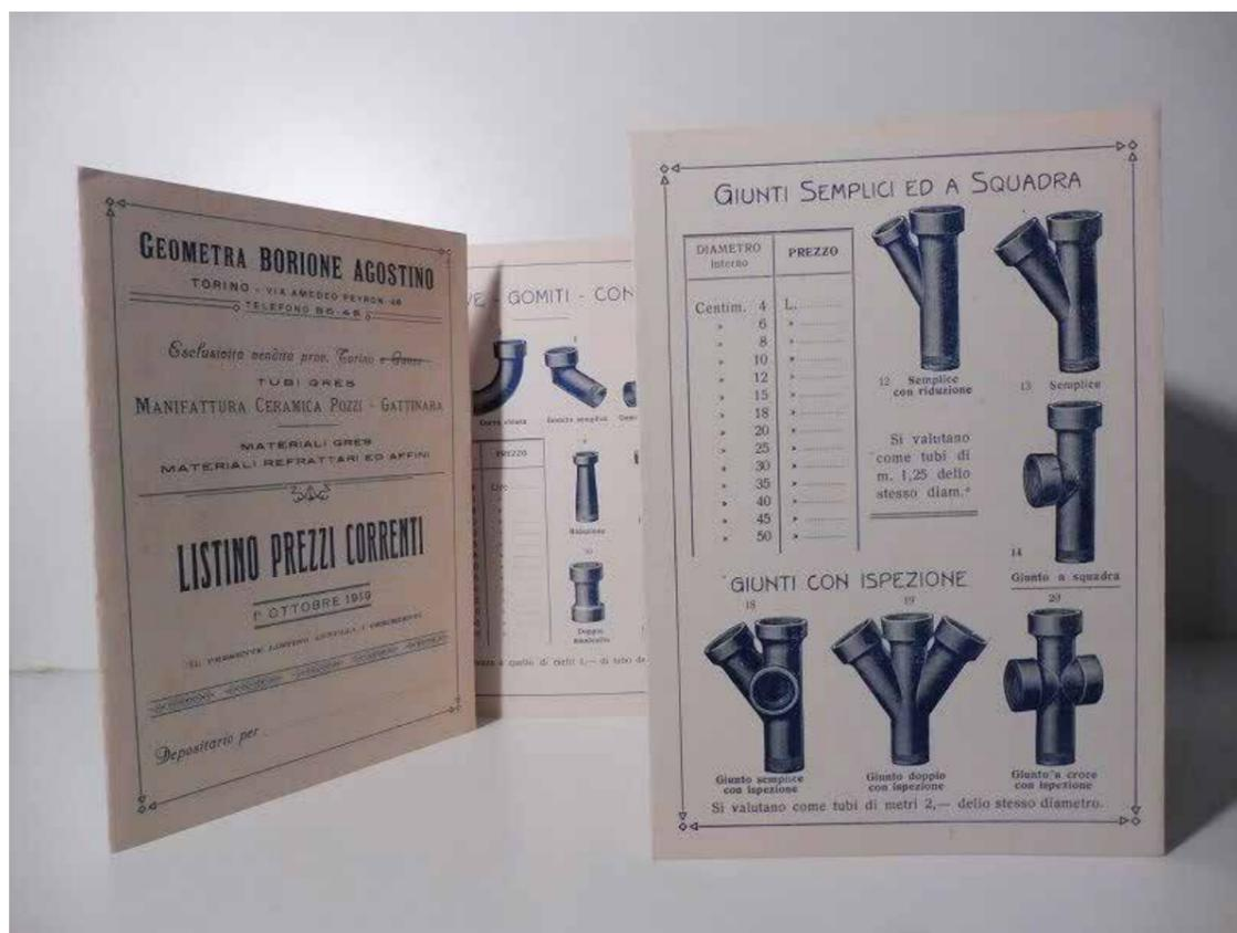
Il GRÈS è un materiale ceramico ottenuto per cottura di argille a temperature superiori ai 1000° C. I primi utilizzi di questo prodotto, da parte della MANIFATTURA CERAMICA POZZI, furono per la realizzazione di tubazioni per le acque reflue (condotte fognarie, scarichi) ed industrie chimiche.
