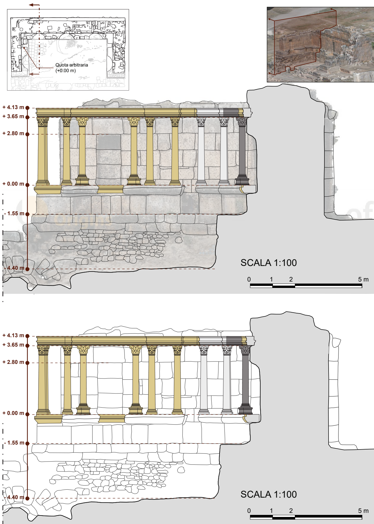
Fig. 4.91: Sezione trasversale ricostruttiva del progetto di anastilosi del Ninfeo del Santuario di Apollo, ricavato dal modello 3D fotogrammetrico e nuvola di punti, sezionato in corrispondenza della nicchia nord del fronte principale
