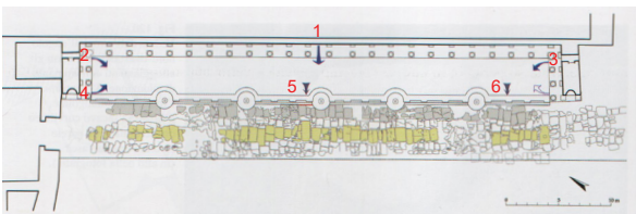
Fig. 2.15: Schema del sistema idraulico della vasca della fontana monumentale in età Imperiale
