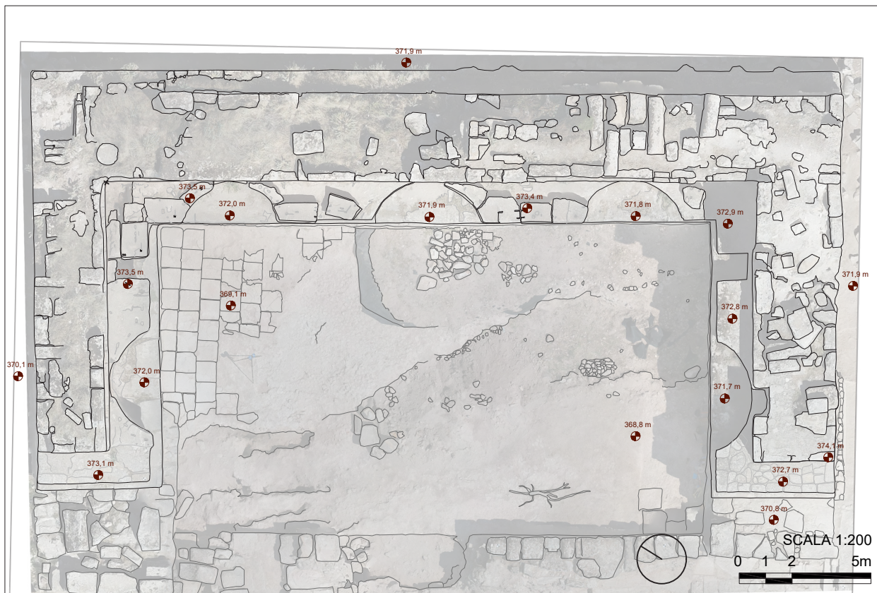
Fig. 4.38: Planimetria delle strutture in situ del Ninfeo del Santuario di Apollo ricavata dal modello 3D fotogrammetrico, con e senza ortofoto.
