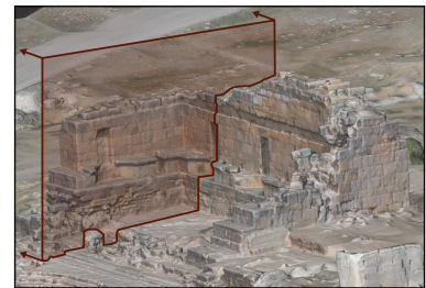
Fig. 4.75: Restituzione modello fotogrammetrico - Sezione trasversale del Ninfeo del Santuario di Apollo con colonne e blocchi fregio-architrave collocati sul modello 3D fotogrammetrico
