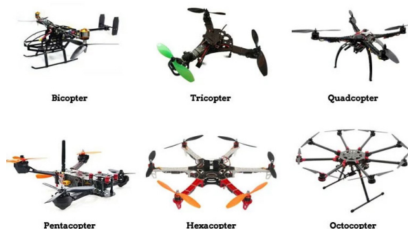
Fig. 3.18: Tipologie di droni a rotore
