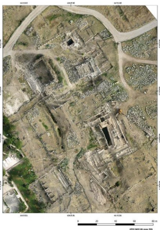
Fig. 3.38: Estratto ortofoto del Santuario di Apollo da modello fotogrammetrico - Area A Realizzata da gruppo di Geomatica del Politecnico di Torino.
