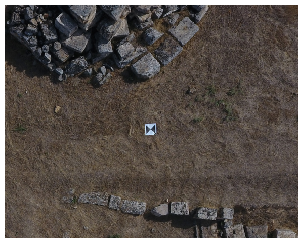
Fig. 3.34: Esempio di posizionamento dei marker sull'oggetto da rilevare, fotografia da volo UAV del 2018
