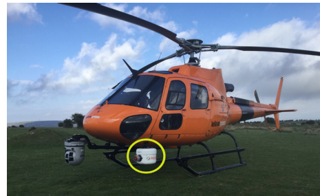
Fig. 3.27: Esempio di aereoelicottero con laser scanner
