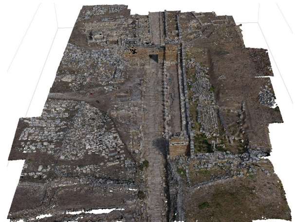
Fig. 4.6: Esempio di nuvola densa di punti da Metashape
