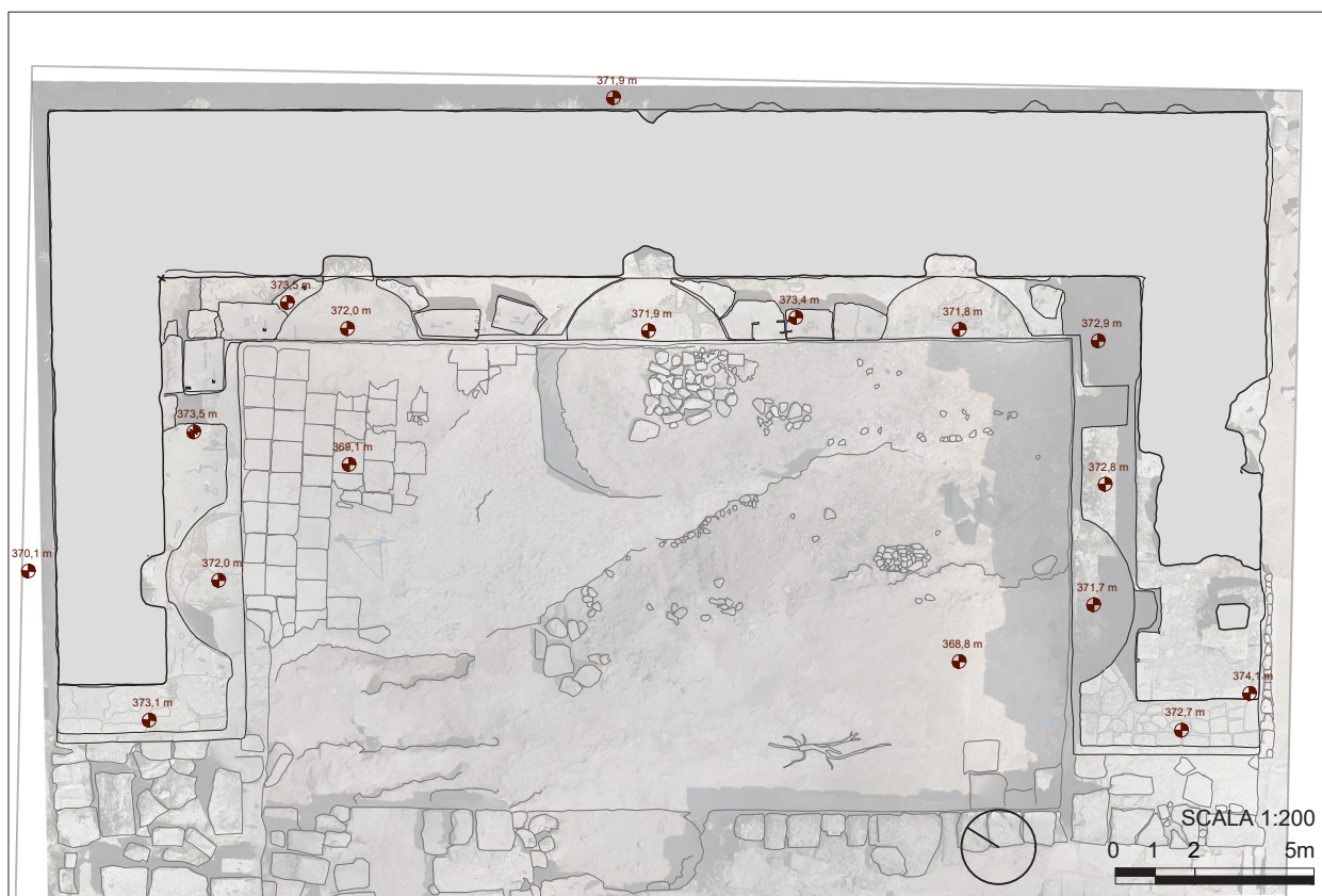
Fig. 4.39: Pianta delle strutture in situ del Ninfeo del Santuario di Apollo ricavata dal modello 3D fotogrammetrico, sezionato a +1m dal Marker D4 posto sulla cornice del podio a quota + 373,527 m slm. Con e senza Ortofoto.
