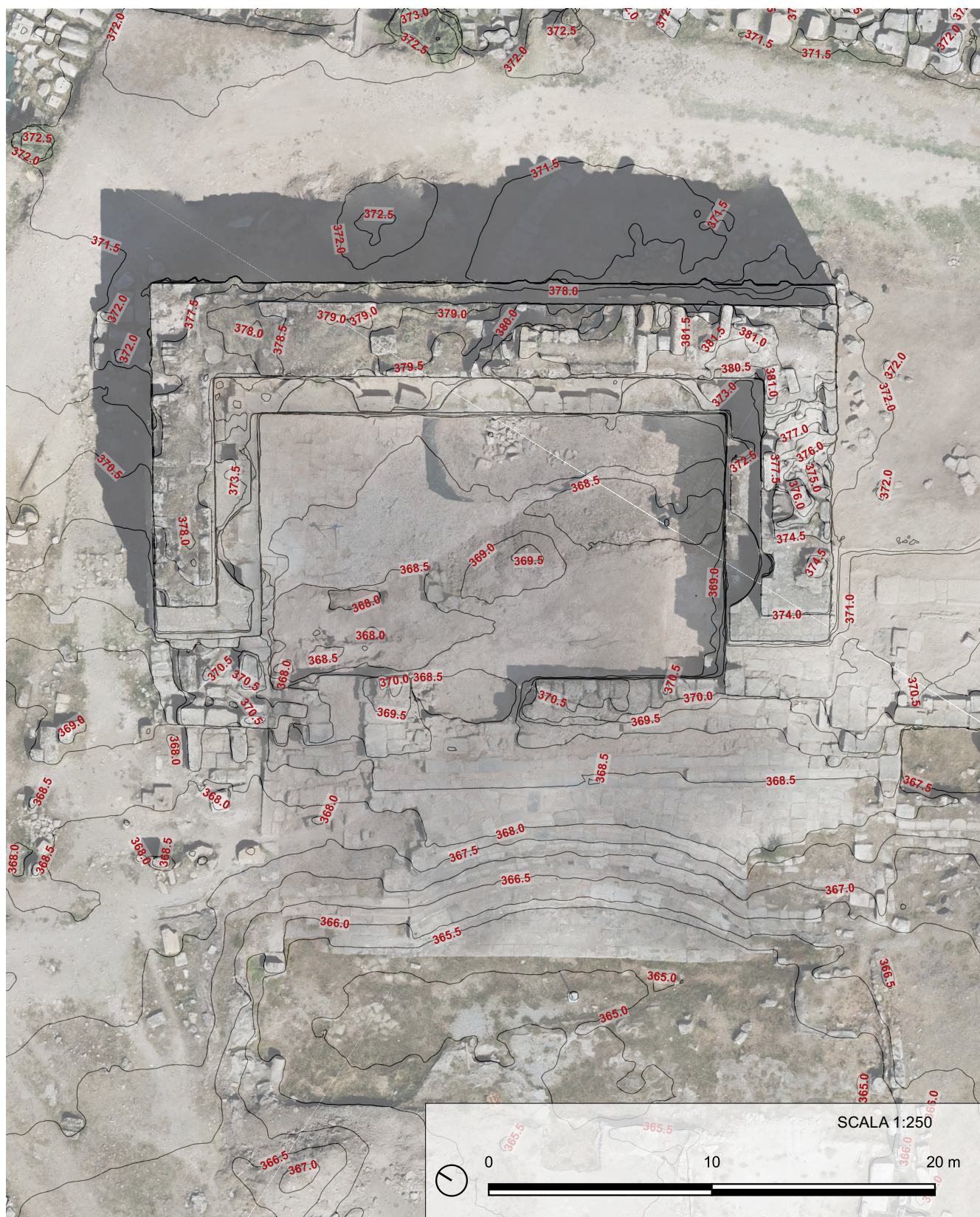
Fig. 4.37: Curve di livello quotate ed estratte da DEM (Digital Elevation Model) con equidistanza di 0.5 m, con ortofoto di sfondo. ricavata da rielaborazione fotogrammetrica del volo UAV (Unmanned Aerial Vehicle) sul Ninfeo dei Tritoni eseguito da gruppo di Geomatica del Politecnico di Torino. GSD=8.52mm/pix
