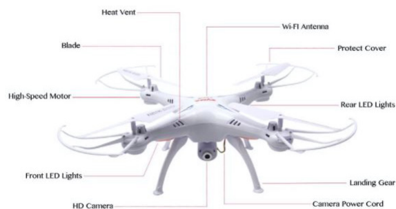
Fig. 3.17 Componenti del drone
