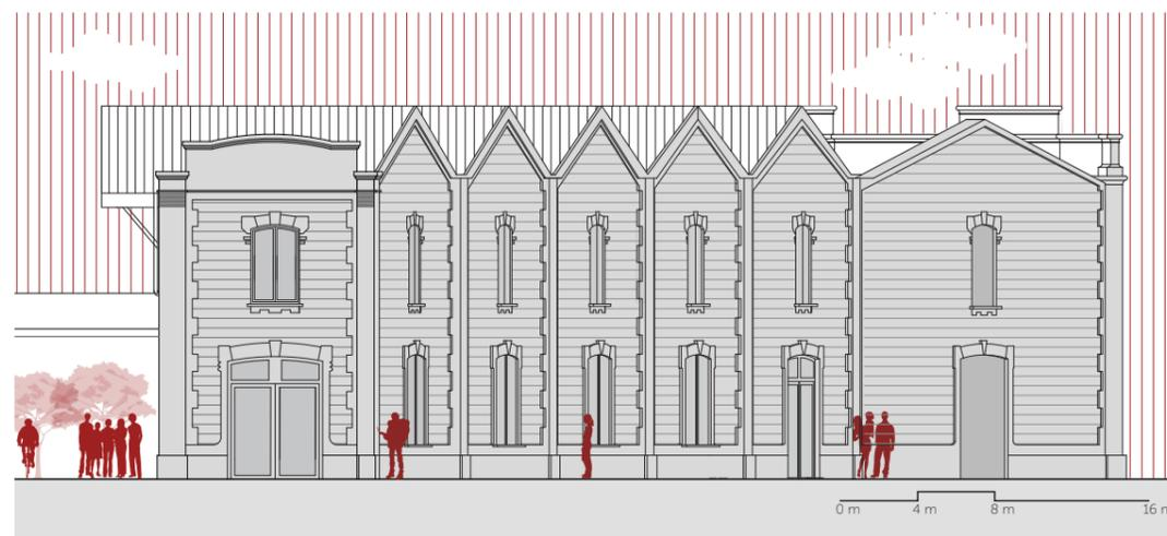
Fig. 54: Prospetto est - scala di dettaglio 1:100
