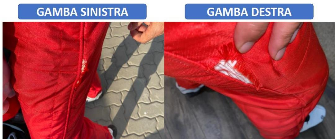
Figura 5-9. Difettosità su tute fornite a Prodrive Motorsport - mod.R557 PRIME+
