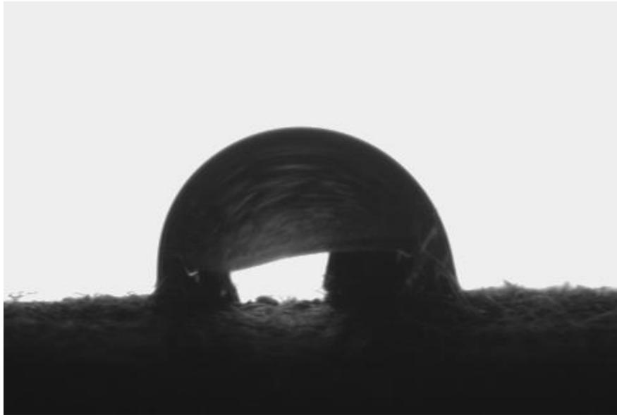
Figura 4-28. Misura dell'angolo di contatto per il TV608 ROSSO, per gentile concessione del Politecnico di Torino
