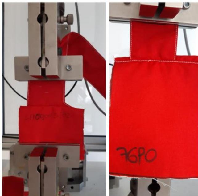
Figura 3-15. Prove di resistenza alla trazione delle spalline previste a fascicolo omologativo della R568
