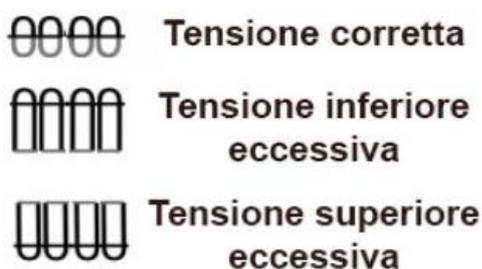
Figura 3-9. Illustrazione delle casistiche di regolazione delle tensioni in una macchina da cucire
