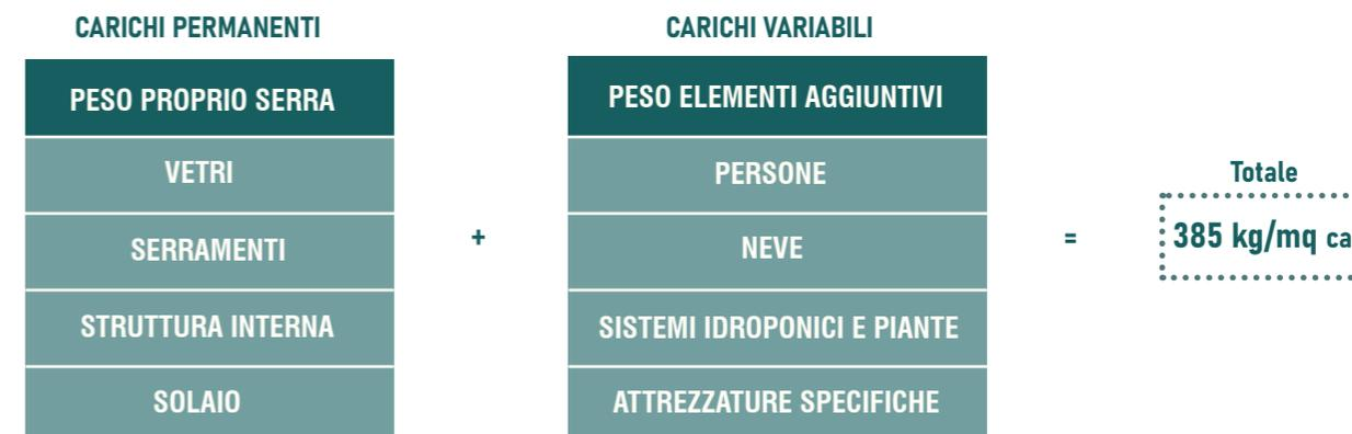
\* E' stata effettuata una stima dei carichi sulla base dei dati tecnici dei materiali scelti per il peso proprio della serra, in aggiunta a misure standard per i pesi portati
