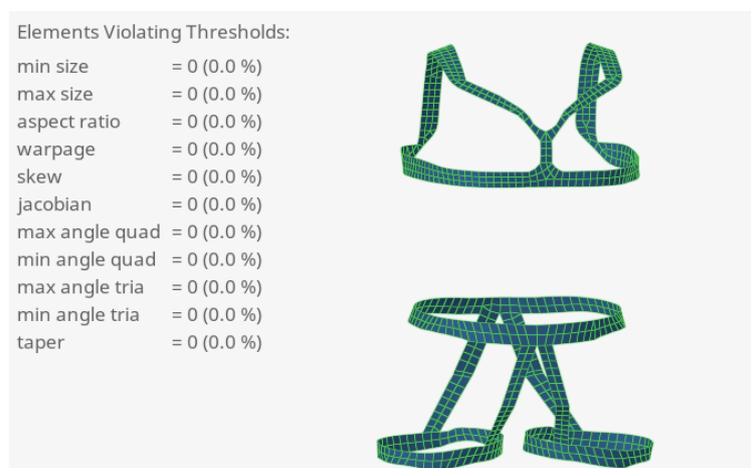
Figura 39. La parte dell'imbrago è stato ottimizzato mediante il tool *QualityIndex*, minimizzando le distorsioni e non generando errori.
