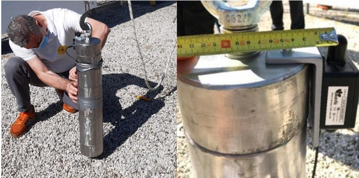
Figura 20. Foto effettuate durante le prove a Padova. A sinistra la preparazione della massa metallica. Il cilindro metallico è approssimativamente di 70mm di raggio, mentre l'accelerometro è posizionato a 90mm dall'asse principale del cilindro, avendo così un offset di 20mm dalla superficie laterale.
