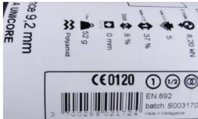
Figura 9. Esempio di etichetta di una corda dinamica, con marchio CE, EN 892 specifico per tale tipologia di corda
