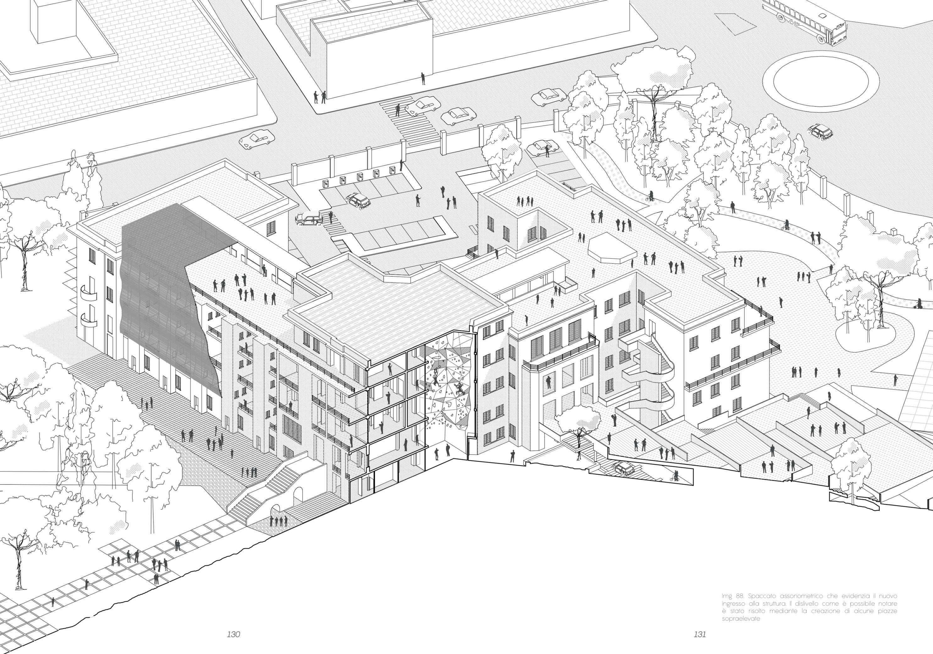
Img 88. Spaccato assometrico che evidenzia il nuovo ingresso alla struttura. Il dislivello come è possibile notare è stato risolto mediante la creazione di alcune piazze sopraelevate
