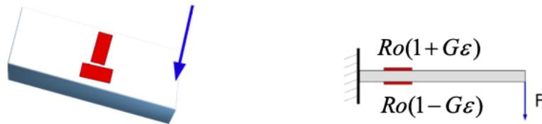
Figura 5.2 A sinistra troviamo il caso con due strain di cui uno attivo e uno passivo. A destra il caso con due strain attivi. [22]
