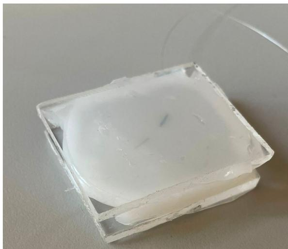
Figura 6.20 Immagine di un supporto realizzato con due strati di plexiglass a cui si interpone uno strato di silicone che contiene il sensore
