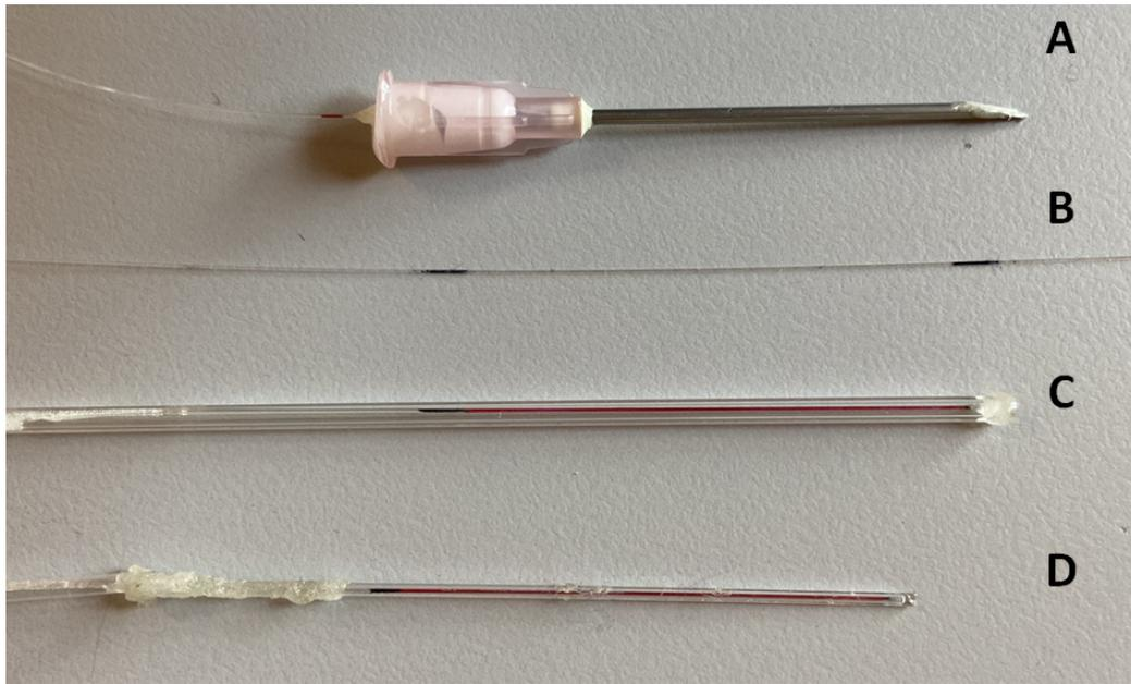
Figura 7.9: A) High-density array n. 1 in ago metallico 18G. B) Straight array n. 4. C) Straight array n. 3 in capillare di vetro (diametro esterno 2 mm). D) Straight array n. 2 in capillare di vetro (diametro esterno 1 mm).
