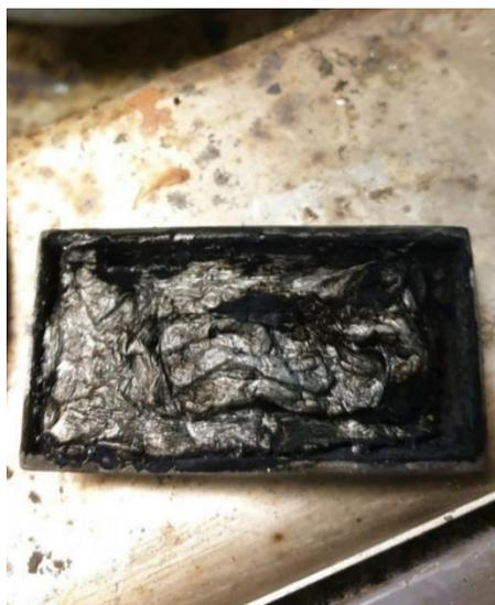
Figura 15: Glucosio riscaldato a 800°C
