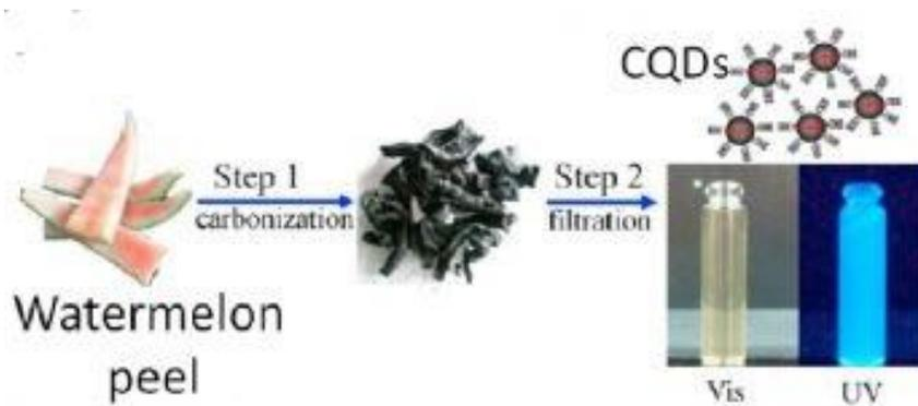
Figura 6: Produzione di carbon dots a partire da scarti di anguria, fonte [3]
