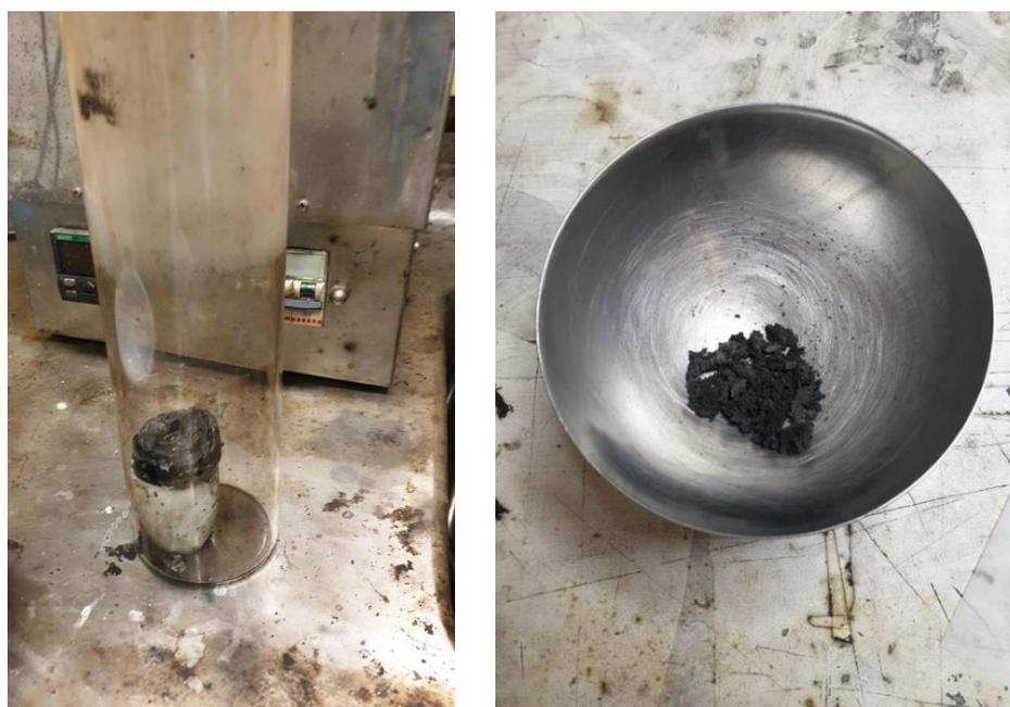
Figura 14: CD ottenuto dal riscaldamento del precursore per 30minuti a 550°C
